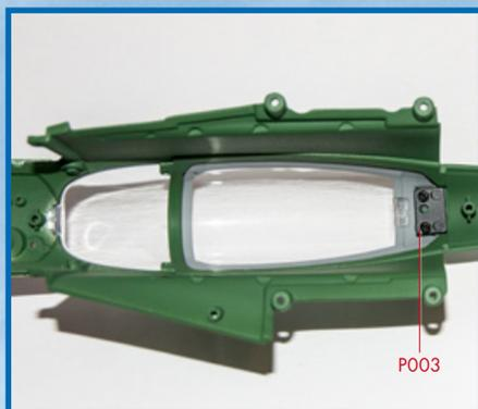
**6** Befestigen Sie die Windschutzscheibe an ihrem Platz mit der Scharnierplatte und zwei Schrauben BM.
