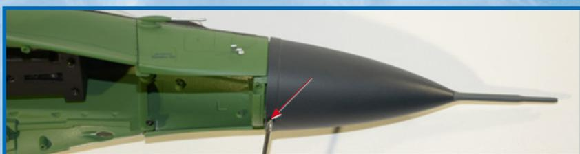
**6** Posiziona il radome (D007) sullo scanner e sulla fusoliera, come mostrato. Fissalo dal basso con una vite DM.
