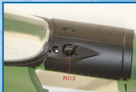
**8** Installa il sensore OLS (P015) nel foro della struttura esterna dell'abitacolo, quindi fissalo dal basso con una vite AR.
