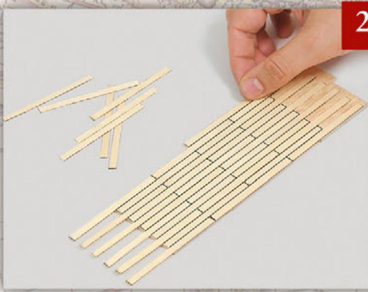
Disponete i corsi di fasciame necessari a rivestire il falso ponte per tutta la sua larghezza. Come avete già fatto in occasione del primo elemento del ponte, lasciate senza tavole la parte posteriore. Completerete il rivestimento successivamente, dopo aver ricevuto e montato l'elemento del ponte adiacente.
