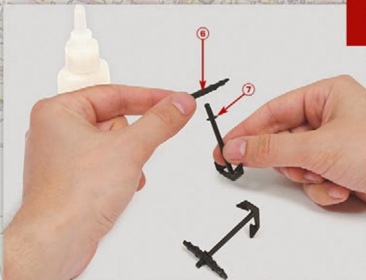
Adesso montate le due ancore: applicate una goccia di adesivo sull'estremità superiore dei fusi, dopodiché infilate questi ultimi all'interno dei fori che ci sono al centro dei relativi ceppi.
