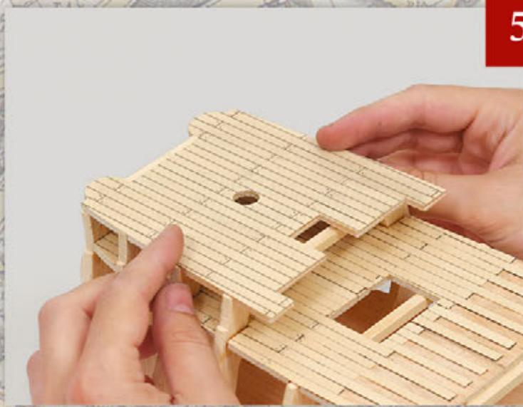
Adesso, montate il ponte del castello di prua sullo scafo, facendo attenzione a incastrarlo correttamente con le sottostanti ordinate. Tenete il ponte in posizione fino a quando la colla non è essiccata esercitando una leggera pressione per far sì che aderisca perfettamente ai tagli delle ordinate.
