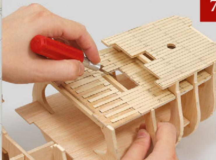
Aiutandovi con un cutter, eliminate la sezione del taglio dell'ordinata 5 che si vede attraverso il boccaporto del ponte.
