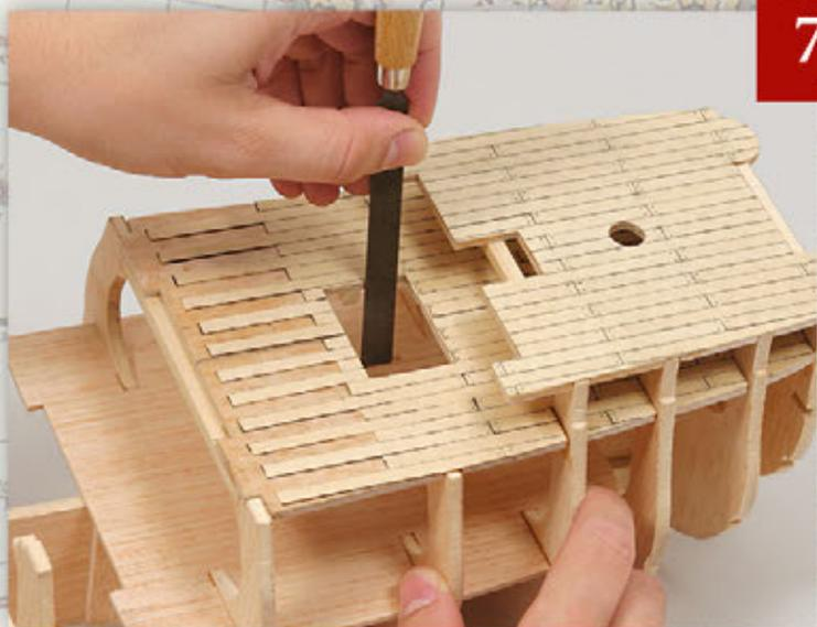
Ripassate i punti di incisione con una lima oppure con la carta abrasiva a grana fine allineando perfettamente i pezzi del taglio rimasti con i bordi del boccaporto del ponte.
