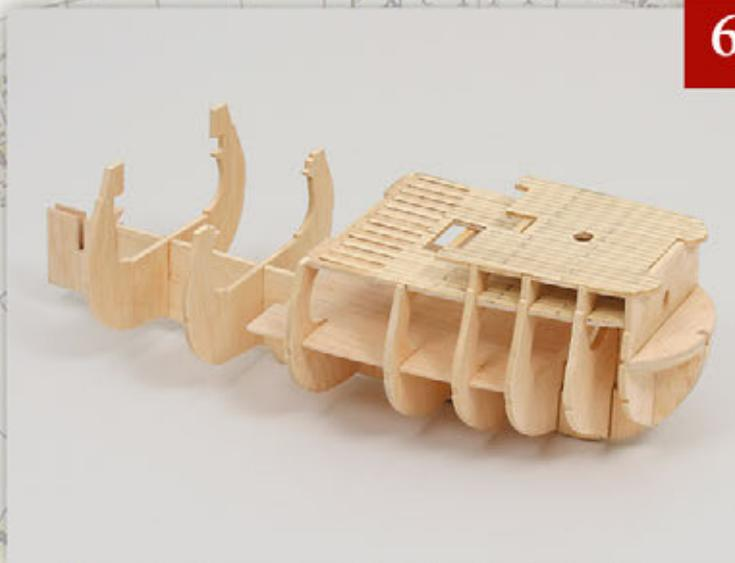
Ecco come si presenta lo scafo al termine della presente sessione di montaggio: nella foto potete vedere le ordinate 7 e 8 correttamente inserite all'interno delle rispettive scanalature e i due rinforzi di unione montati sull'estremità posteriore della falsa chiglia intermedia.
