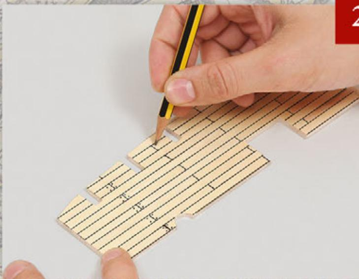
Per simulare la chiodatura del ponte, tracciate a matita due segni su entrambi i lati delle giunzioni tra una tavola e l'altra, come mostrato nell'immagine a fianco e analogamente a quanto avete già fatto nell'uscita precedente per il primo elemento del ponte.
