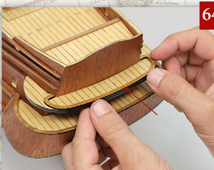
Incollate la cornice mostrata in foto sulla faccia superiore del giardinetto superiore di poppa. Se necessario, rifinitela con la carta abrasiva a grana fine in modo che combaci perfettamente con il bordo esterno del giardinetto e con le estremità delle due fiancate.
