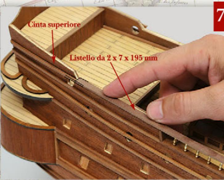
Ricavate un pezzo lungo 195 mm da un listello di mogano da 2 x 7 x 300 mm e incollatelo sulle dieci colonnine e sull'impavesata del cassero, in modo da realizzare il corrimano del parapetto destro del cassero.
