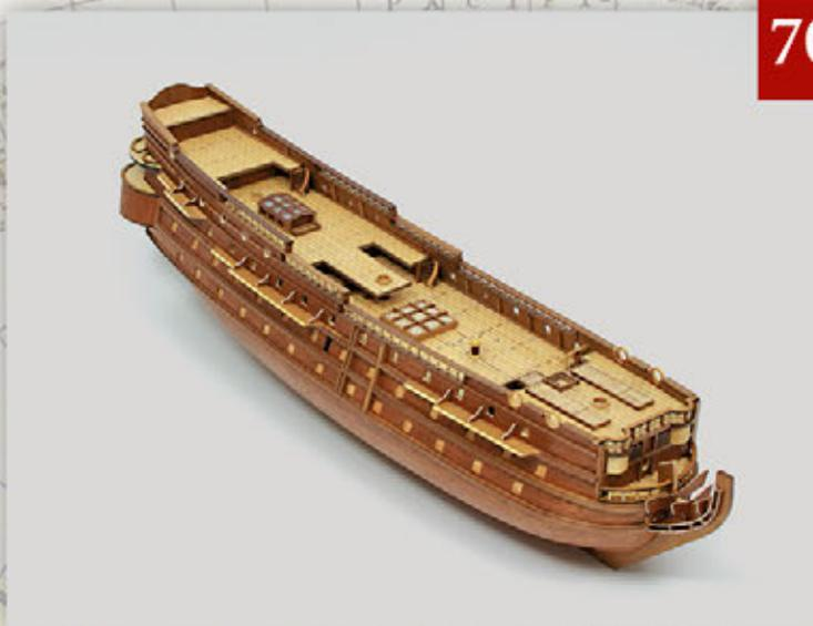
Analogamente a quanto avete realizzato nelle fasi 70g-70j, montate anche i tre parasartie della fiancata destra. Conservate quindi il modello in attesa di ricevere la successiva sessione di montaggio.
