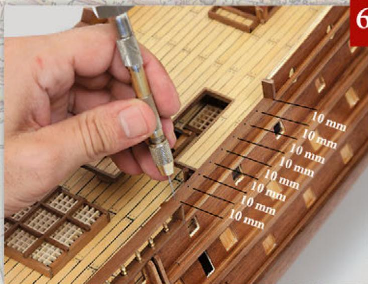
Recuperate il modello e realizzate otto fori sulla sezione poppiera del listello di mogano da 2 x 7 x 300 mm che avete usato per realizzare il corrimano dell'impavesata sinistra del ponte di coperta. Gli otto fori devono distare 10 mm l'uno dall'altro, come indicato in foto.
