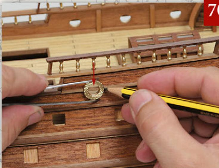
Recuperate una delle cornici tonde per le cannoniere allegate al fascicolo 62 e appoggiatela sulla fiancata sinistra, in corrispondenza della prima cannoniera della sezione poppiera del ponte superiore di batteria. Quindi segnate a matita la sezione della cinta che dovrete eliminare.
