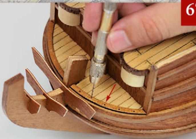
Con un trapano a mano, realizzate cinque fori su entrambe le bordature del ponte della ruota di prua. Vi consigliamo di realizzare prima il foro centrale, in modo che le aperture siano equidistanti l'una dall'altra.
