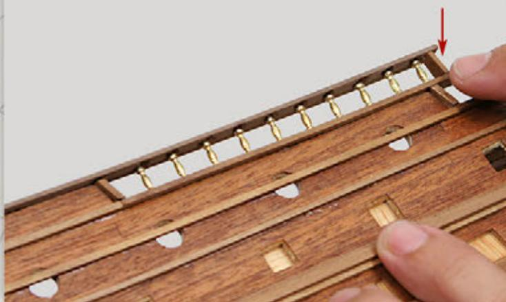
Fissate un pezzo di listello da 2 x 7 x 300 mm tra il corrimano e il sottostante capo di banda, in modo da completare il parapetto destro del cassero.
