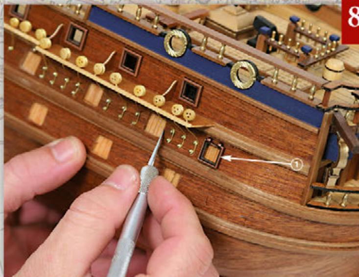
Rifinite i bordi delle cannoniere della fiancata destra con un cutter ben affilato, in modo da adattare alle cornici dei portelli che dovrete montare su di esse.
