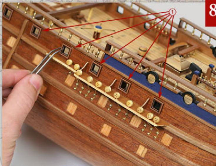
Recuperate il modello del *San Felipe* e montate le cornici dei portelli all'interno di tutte le cannoniere del terzo ponte di batteria della fiancata destra.
