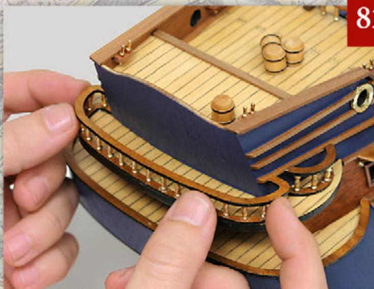
Levigate la cornice, dipingetela con una vernice trasparente opaca e coloratene di nero i bordi, infine montatela sulle colonnine che avete fissato sul giardinetto superiore di poppa. Collocate la cornice in modo che le sue estremità combacino con la prima delle tre cinte che corre lungo la sezione poppiera di entrambe le fiancate.
