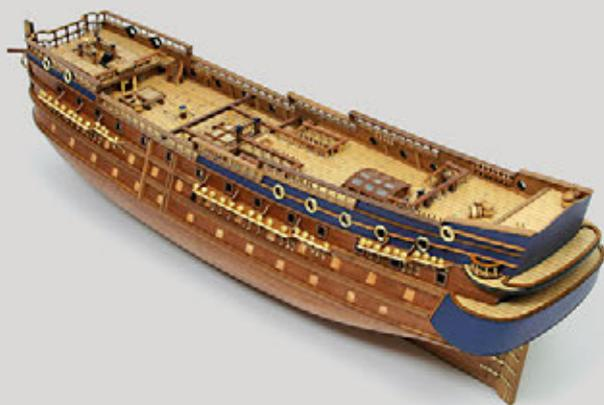
La foto mostra il modello del *San Felipe* dopo che avrete montato le cornici delle cannoniere del terzo ponte di batteria, le ultime bigotte dei parasartie, le cornici decorative di prua e le colonnine di poppa.
