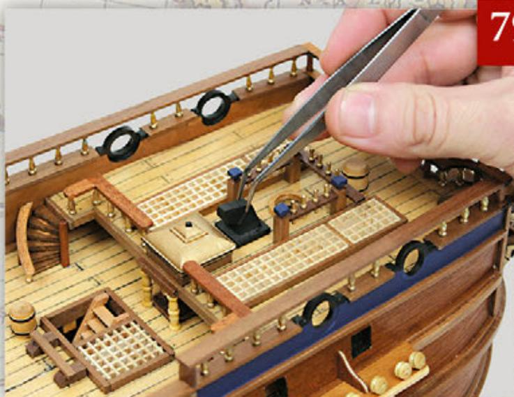
Recuperate il camino allegato all'uscita 78 e incollatelo sul ponte del castello di prua, tra l'alloggiamento per l'albero di trinchetto e la chiesuola della campana.
