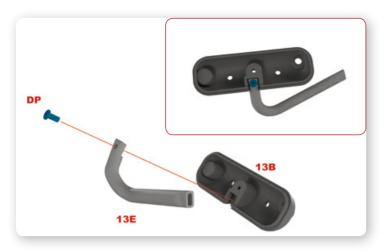
Setzen Sie das Abgasrohr (13E) in Teil 2 des Auspuffrohres (13B) ein und sichern Sie es mit einer Schraube DP.
