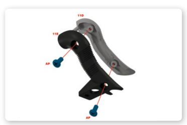
4 Verbinden Sie die beiden Hälften des Heizungsrohres (11D und 11E) mit zwei Schrauben AP.
