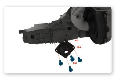
**2** Befestigen Sie nun die zweite Verbindungsabdeckung (11A) auf der anderen Seite des Getriebegehäuses mit vier weiteren Schrauben AM.
