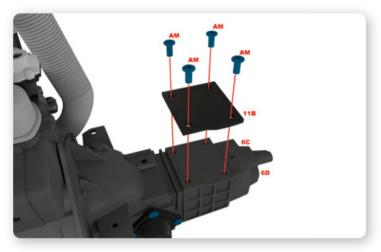
Positionieren Sie den oberen Getriebedeckel (11B) über dem Getriebegehäuse, indem Sie die Löcher auf beiden Seiten ausrichten und ihn mit vier Schrauben AM sichern.
