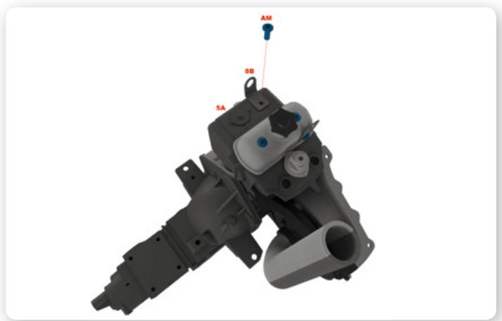
**4** Legen Sie nun den Kabeldurchgang für die Hochspannungskabel 1 (8B) auf den Motor und sichern Sie ihn mit einer Schraube AM.
