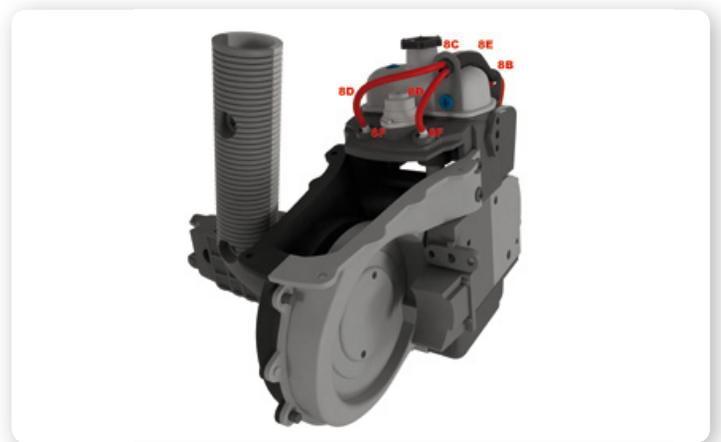
**8** Schieben Sie die Schutzhülle durch beide Kabeldurchgänge und verbinden Sie dann die Enden der einzelnen Hochspannungskabel mit einer der Zünderzen.
