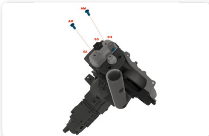
**3** Setzen Sie den Ventildeckel über den Motor und sichern Sie ihn mit zwei Schrauben AM.
