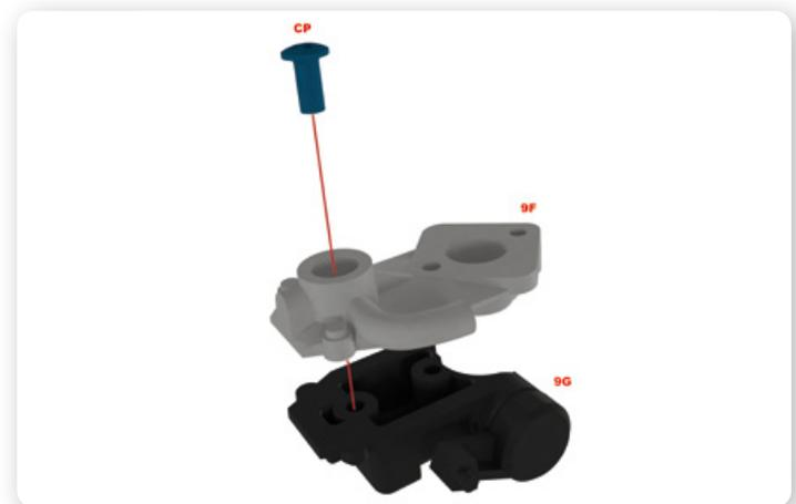
**6** Verbinden Sie die Teile des Vergasers (9F und 9G) mit einer Schraube CP.
