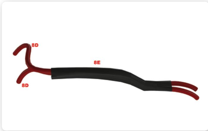
**7** Verlegen Sie die Hochspannungskabel (8D) durch die Schutzhülle (E).
