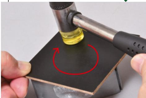
Positionieren Sie das Brettchen und schlagen Sie mit dem Hammer darauf, um das Räderwerk komplett einzusetzen.
