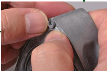
Drücken Sie leicht, um die Dichtung einzusetzen.
