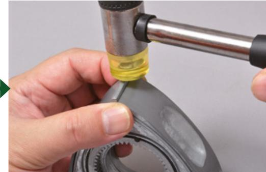
Klopfen Sie mit dem Hammer auf die drei Kanten, bis sie bündig sind.
