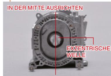
Drehen Sie die exzentrische Welle, um sie wie auf dem Foto gezeigt auszurichten.
