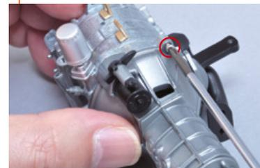
Entfernen Sie die angegebene Schraube.
