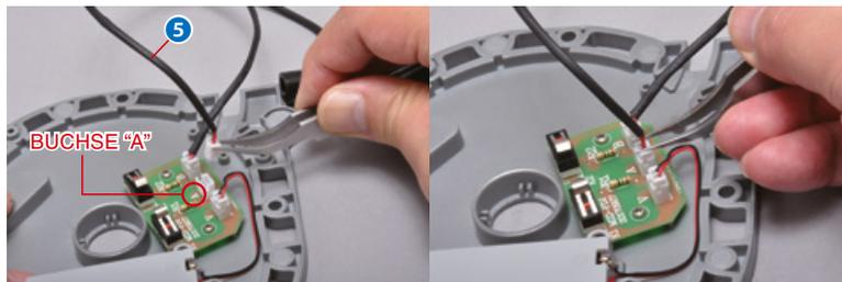
Stecken Sie den Stecker des Elektrokabels in die Buchse "A" des Steuergeräts.
