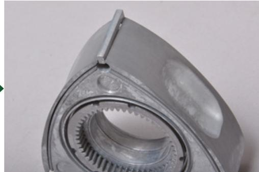
Drücken Sie gleichmäßig nach unten, so dass die Kanten nicht über das Rotorprofil hinausragen.
