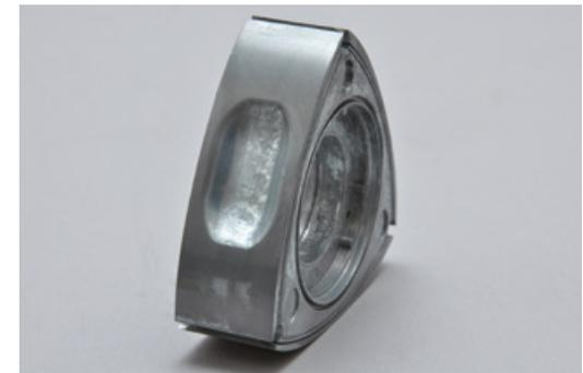
Schlagen Sie mit dem in diesem Schritt erhaltenen Hammer an den Scheitelpunkten des Rotors auf das Brettchen, um die Komponenten vollständig einzusetzen.
