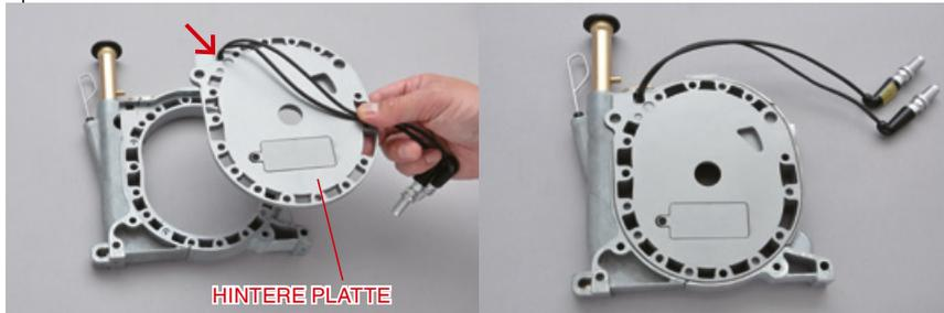
Installieren Sie die hintere Platte unter Beachtung der auf dem Foto gezeigten Ausrichtung. Die Elektrokabel müssen aus der angegebenen Aussparung austreten.
