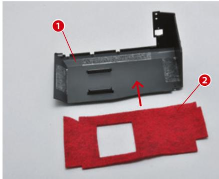
Entfernen Sie die Schutzfolien von allen Streifen des doppelseitigen Klebebands.
