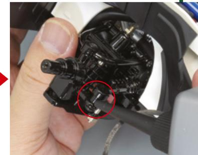
Tragen Sie eine kleine Menge Schmiermittel auf den Teil der Aufhängung auf, der auf dem Foto durch den Kreis hervorgehoben ist, wo das Ende der Zugstange sitzt.
