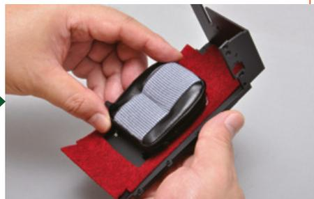
Installieren Sie das Kissen auf dem Abschnitt der Bodenplatte. Prüfen Sie, ob der Schiebehebel zwischen der Matte und dem Kissen positioniert ist.
