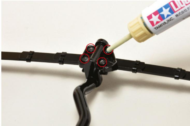
Tragen Sie eine kleine Menge Gewindekleber auf die vier Schraubenspitzen auf.
