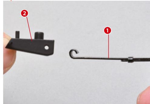
Verbinden Sie nun den Bügel A mit dem anderen Ende der Blattfeder, indem Sie die Teile wie gezeigt ausrichten.
