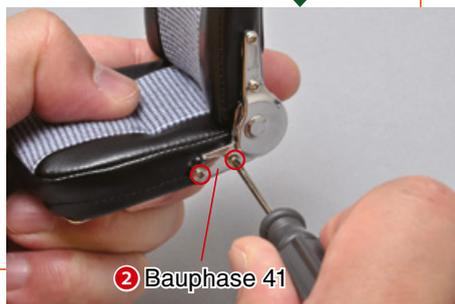
Ziehen Sie in gleicher Weise zwei der Schrauben, die Sie als Anlage zu Bauphase 41 erhalten haben, an den angegebenen Stellen fest.
