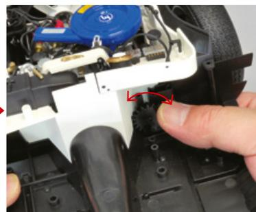
Heben Sie Ihr Modell an und versuchen Sie, die Lenkwelle wie in der Abbildung gezeigt zu drehen. Sobald das Schmiermittel aufgetragen ist, sollten sich die Räder leicht drehen.
