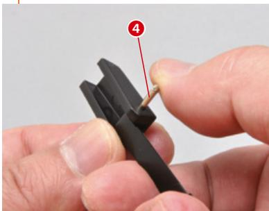
Stecken Sie den langen Stift in die Durchgangslöcher.
