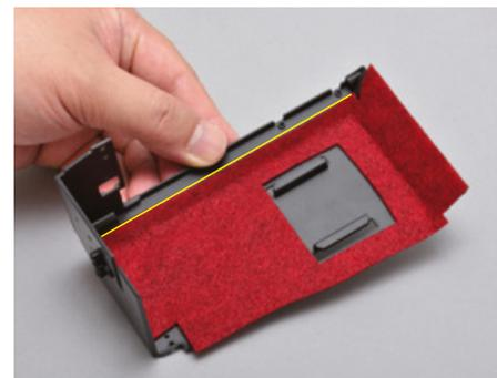
Richten Sie die lange Seite aus und drücken Sie sie an, um sie auf den entsprechenden Streifen des doppelseitigen Klebbands zu kleben.
