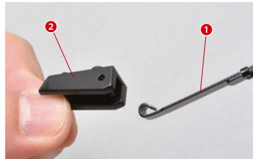
Verbinden Sie nun den Bügel A mit dem anderen Ende der Blattfeder und richten Sie die Teile wie gezeigt aus.
