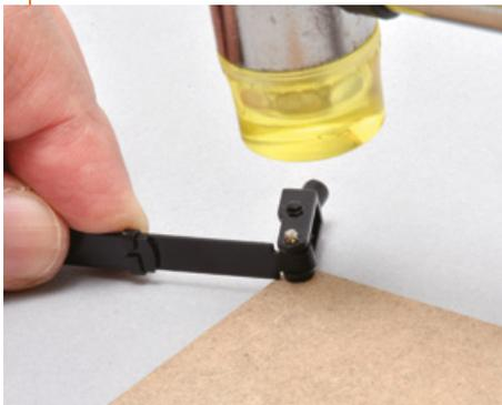
Nehmen Sie das in Bauphase 17 beigefügte Brettchen und den Hammer und klopfen Sie auf den Stift, um ihn vollständig einzusetzen.
