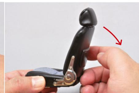
Prüfen Sie, ob sich der Sitz in beide Richtungen leichtgängig biegen lässt. Achten Sie darauf, dass Sie die Bauteile nicht beschädigen.
