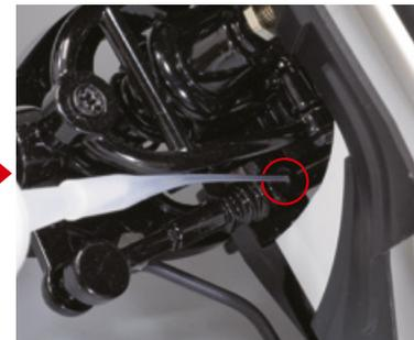
Wenn sich die Zugstangenschraube (im Bild dargestellt) löst, können Sie einen Tropfen Sekundenkleber auftragen, um sie zu fixieren. Ziehen Sie vorher die Schraube an und lösen Sie sie ca. 1/4 Umdrehung, dann tragen Sie etwas Klebstoff in das Loch auf (vom gegenüberliegenden Ende des Schraubenkopfes).
