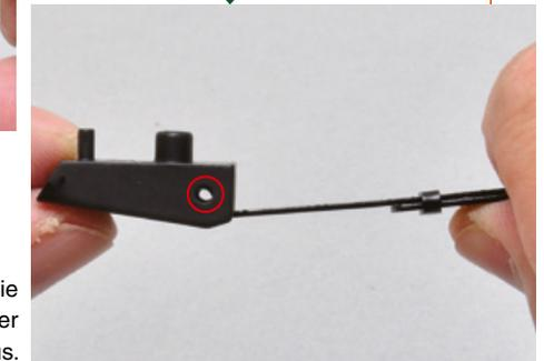
Richten Sie die Durchgangslöcher der beiden Teile aus.
