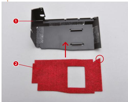
Entfernen Sie die Schutzfolien von allen Streifen des doppelseitigen Klebbands.
