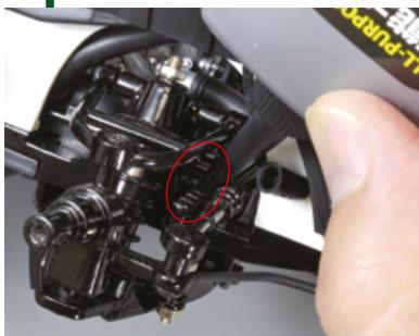
Tragen Sie eine kleine Menge Schmiermittel auf den flachen Teil des Zugstangengetriebes auf, der auf dem Foto hervorgehoben ist.
