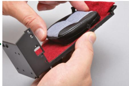
Installieren Sie das Kissen auf der Bodenplatte. Achten Sie darauf, dass der Schiebehebel zwischen der Matte und dem Kissen positioniert ist.
