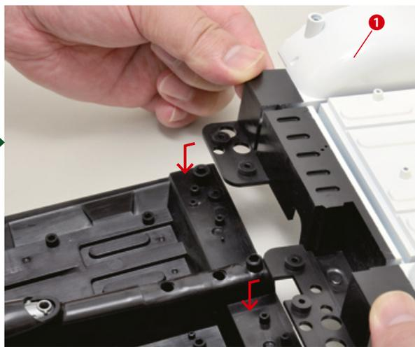
Fügen Sie die Bauteile zusammen, indem Sie die auf dem Foto gezeigten Verriegelungselemente zusammenfügen.
