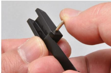
Stecken Sie den langen Stift in die Durchgangslöcher.
