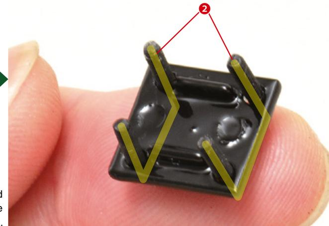
Die beiden Bolzen sind korrekt mit der Platte verbunden.
