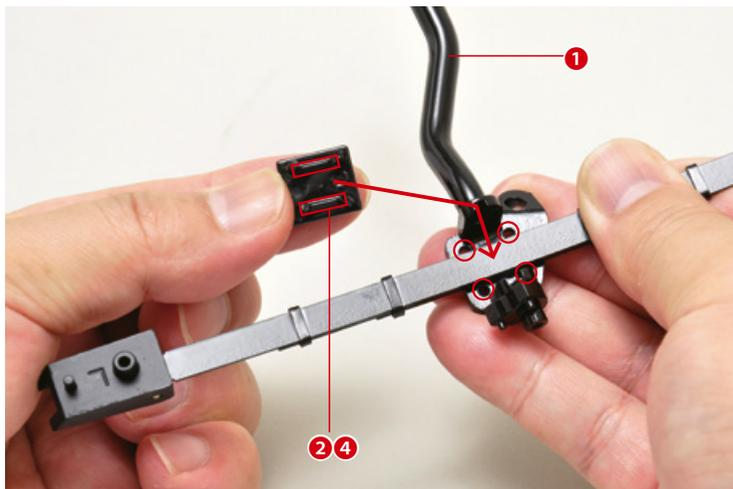
Verbinden Sie die Platte mit den Bolzen mit der Brücke und der linken Blattfederbaugruppe.
