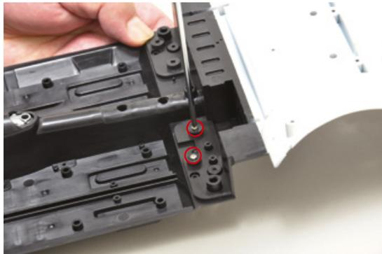
Ziehen Sie zwei der an dieser Bauphase beigefügten Schrauben an den angegebenen Stellen fest.
