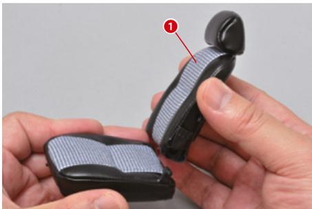
Nehmen Sie das Sitzkissen aus der Bodenplatte, um es mit der Rückenlehne zu verbinden.
