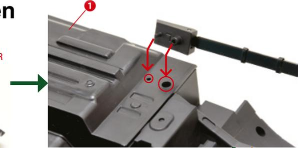
Stecken Sie die Stifte des Bügels A der linken Blattfeder in die auf dem Foto markierten Löcher in der Bodenplatte; verfahren Sie mit der rechten Blattfeder genauso.
