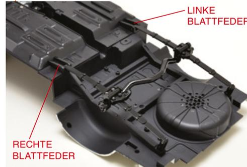
Montieren Sie provisorisch die hinteren Aufhängungen an Ihrem Modell, wie abgebildet. In einem der nächsten Bauphase werden Sie sie dauerhaft anschließen.
