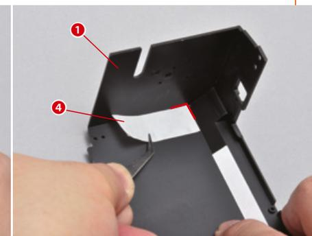
Bringen Sie auf die gleiche Weise die beiden kurzen Streifen am Abschnitt R der Bodenplatte an, und zwar an den auf dem Foto angegebenen Stellen.
