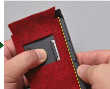
Richten Sie die lange Seite aus und drücken Sie sie an, um sie auf den entsprechenden Streifen des doppelseitigen Klebebands zu kleben.
