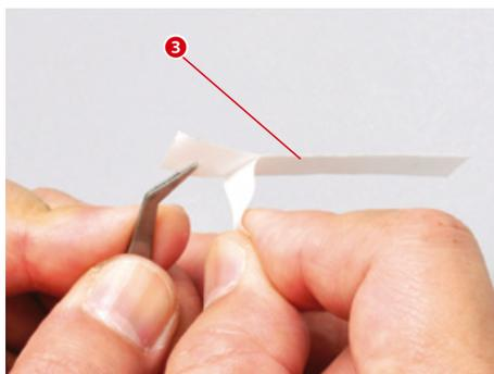
Entfernen Sie die Schutzfolie von einer Seite des langen Streifens des doppelseitigen Klebebands.
