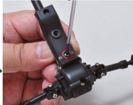
Sichern Sie die Teile mit einer Schraube des Typen A, ohne sie ganz anzuziehen.
