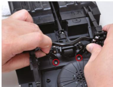
Stecken Sie die Enden der hinteren Stoßdämpfer in die gezeigten Löcher.
