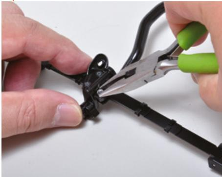
Heben Sie den Bolzen wie gezeigt etwa 1 mm an.
