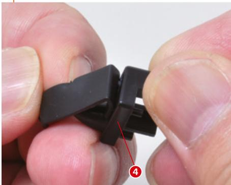
Die beiden Anschlagpuffer bestehen aus Harz und Gummi; die Bauteile sollten bereits ordentlich verklebt sein.
