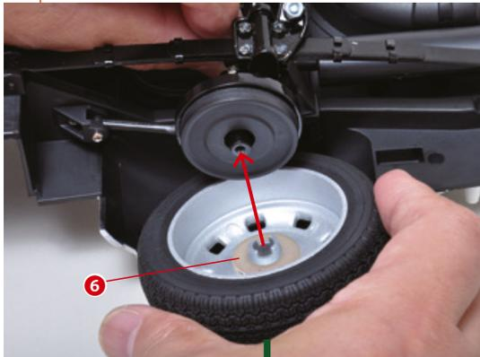
Holen Sie das in Bauphase 52 montierte Rad zurück und setzen Sie die Unterlegscheibe auf der Innenseite ein. Verbinden Sie das Rad mit dem anderen Ende der Hinterachse.
