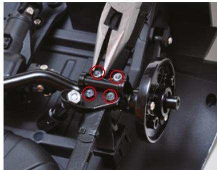
Verbinden Sie die linke Trommel mit der linken Bremsscheibe, indem Sie die Teile wie abgebildet ausrichten.
