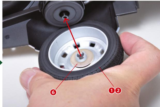
Stecken Sie die Unterlegscheibe auf den Stift an der Felgeninnenseite. Verbinden Sie das Rad mit dem Ende der Hinterachswelle.
