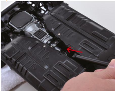
Richten Sie den Hauptkörper Ihres Modells wie abgebildet aus und verbinden Sie die Welle, die Sie in Schritt 4 entfernt haben, mit dem Getriebe.
