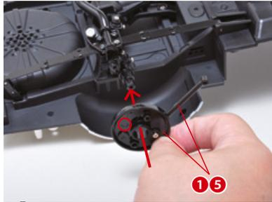
Verbinden Sie die linke Scheibe mit dem entsprechenden Ende der hinteren Aufhängung, wie abgebildet.
