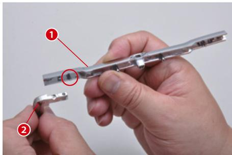
Richten Sie die Teile wie abgebildet aus und verbinden Sie das L-Profil mit der Stoßfänger.
