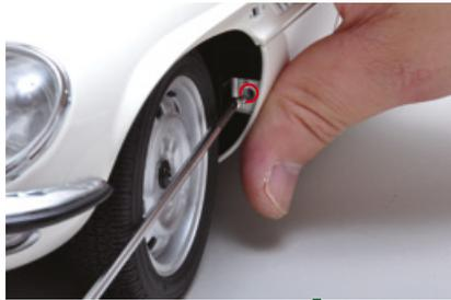
Ziehen Sie eine weitere Schraube in dem im Bild gekennzeichneten Loch hinter dem linken Vorderrad fest.
