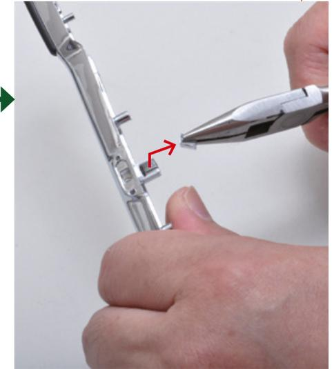
Entfernen Sie das abgebildete Segment; jetzt besteht keine Gefahr mehr, dass die Stoßstange die LED beschädigt.
