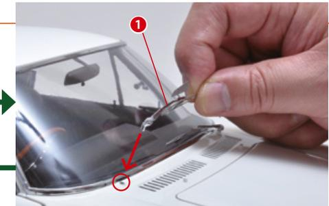
Installieren Sie in ähnlicher Weise auch den Scheibenwischer R, indem Sie die Teile wie abgebildet ausrichten.
