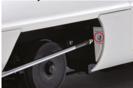
Ziehen Sie eine in dieser Bauphase erhaltene Schraube in die angegebene Bohrung ein. Positionieren Sie das Rad anschließend neu.
