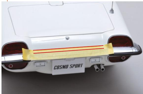
Kleben Sie einen Streifen Klebeband auf den hinteren Teil Ihres Modells, wie abgebildet. Der auf dem Foto rot dargestellte Abschnitt misst ca. 5 mm.
