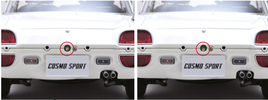
Überprüfen Sie die Position der LED der Kennzeichenbeleuchtung. Wenn sie bereits zentriert ist (wie im ersten Bild), gehen Sie direkt zu Schritt 4; andernfalls ändern Sie die Stoßstange wie gezeigt.
