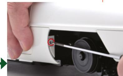
Wenn Sie Schwierigkeiten haben, drücken Sie den Blechstreifen, um die Schraubenlöcher auszurichten. Positionieren Sie das Rad anschließend neu.
