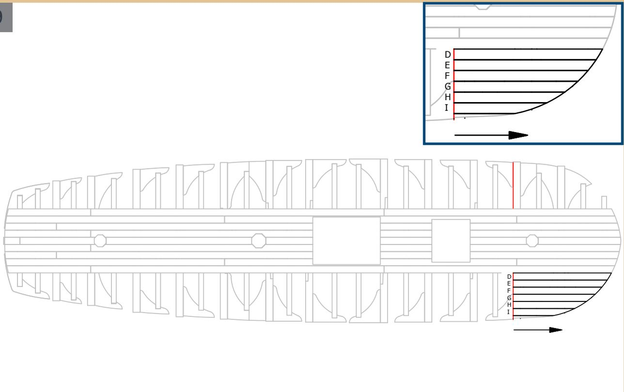
9 Schauen Sie sich das Schema genau an und positionieren Sie die Teile D, E, F, G, H und I, die Sie im vorherigen Schritt erhalten haben.
