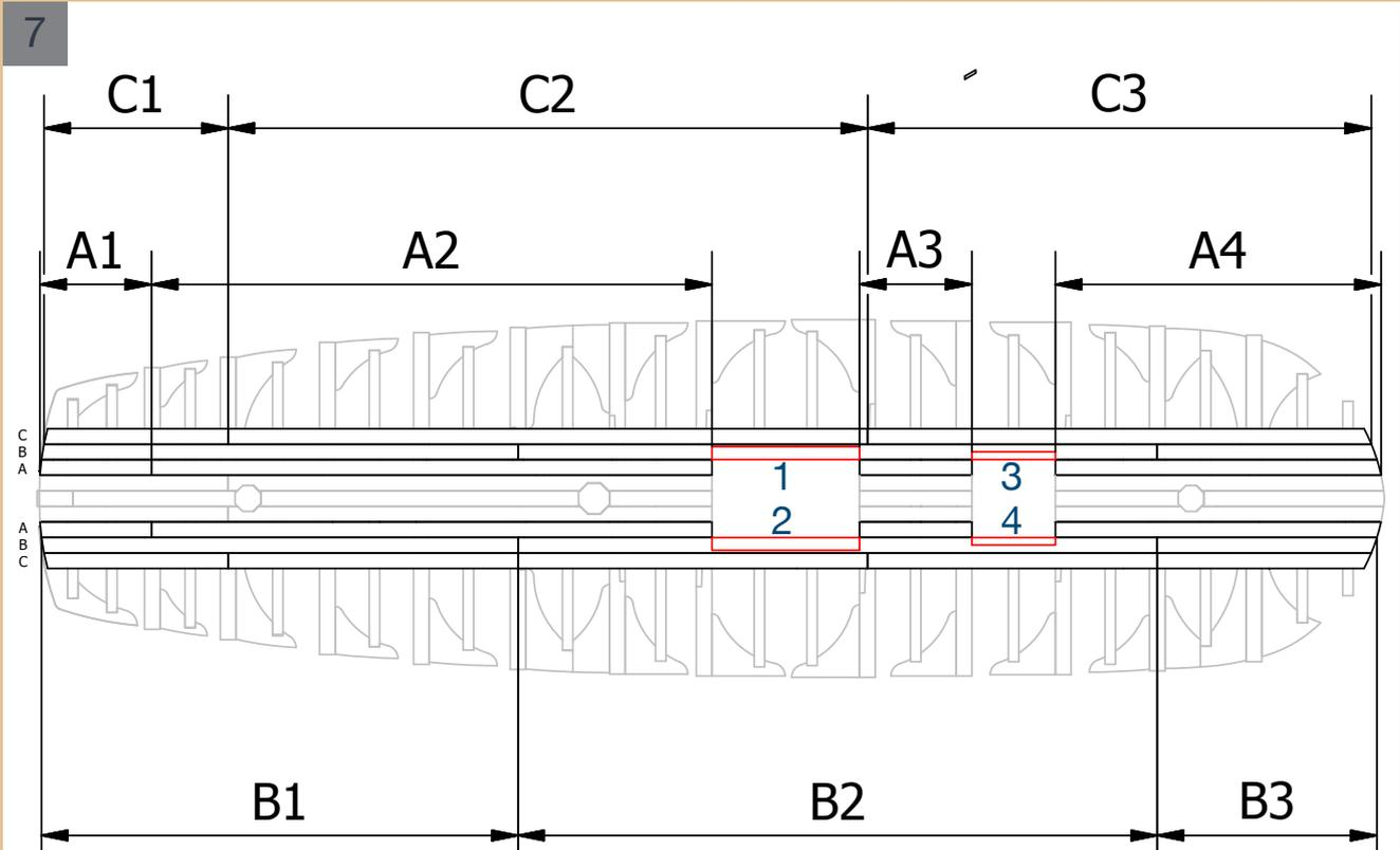
7 Nehmen Sie 16 Holzlatten und verwenden Sie sie wie in den Schemata der Zeichnungen 7, 8 und 9 dargestellt. Verwenden Sie 8 Holzlatten pro Seite (Zeichnung 8). Nach dem Verkleben aller Latten entfernen Sie die rot markierten Teile (1, 2, 3 und 4, dargestellt in Zeichnung 7).
