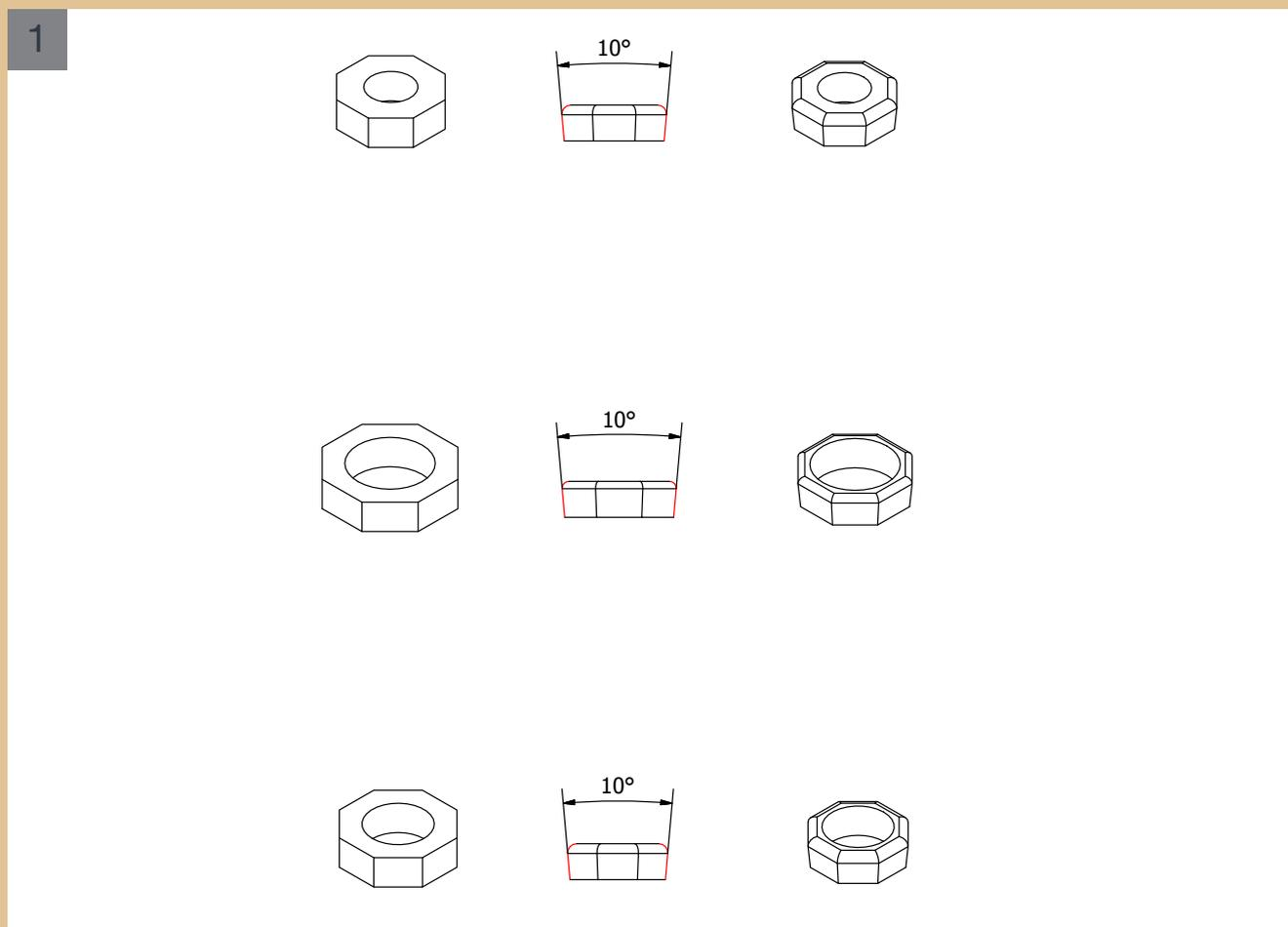
1 Entfernen Sie die Teile 1, 2 und 3 aus dem Holzbrettchen 7-06. Schrägen Sie die oberen drei Teile um  $10^\circ$  ab, um sie an das Deck anzupassen.
