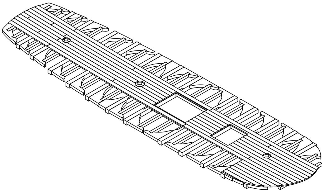
10 Die mittleren Holzlatten und die Beplankung der Bugseite richtig positioniert.
