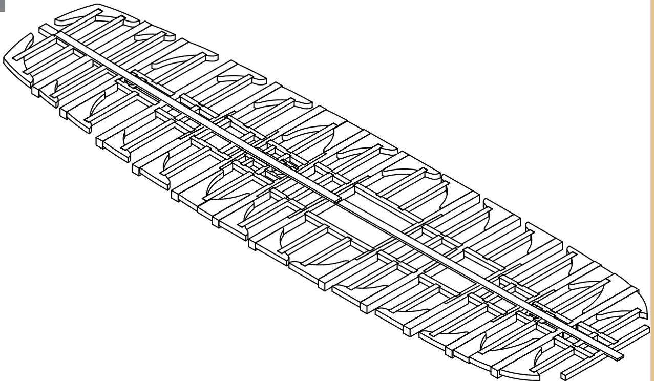
2 Die zwei Holzplatten korrekt positioniert.
