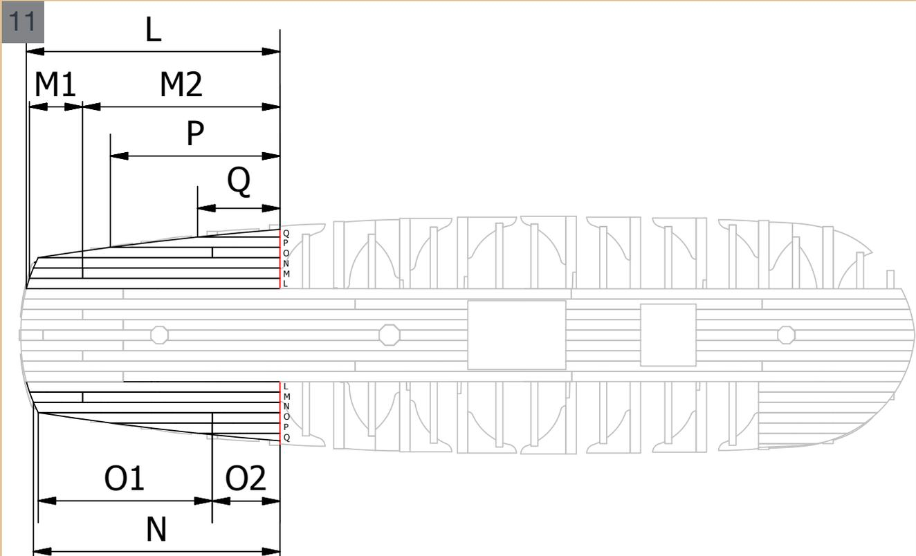
11 Nehmen Sie 6 Holzplatten und formen Sie sie nach dem in den Zeichnungen 11 und 12 gezeigten Schema. Verwenden Sie 3 Holzplatten pro Seite.
