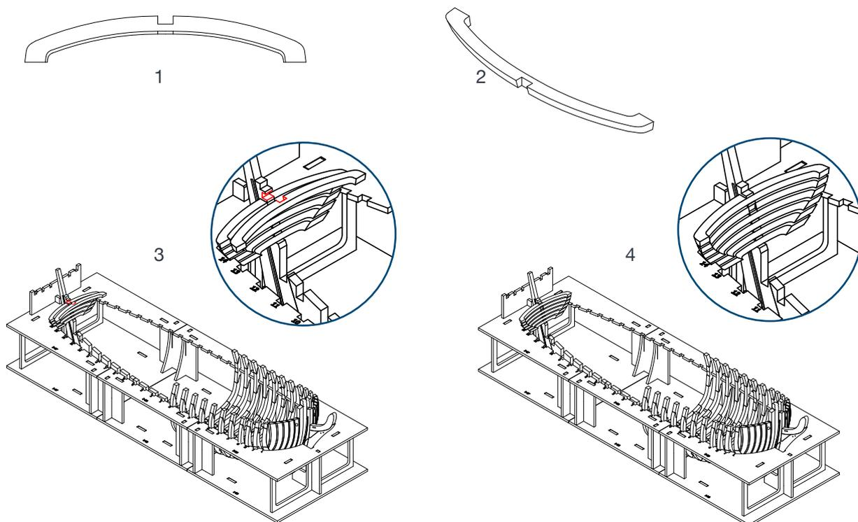
18 Il disegno 1 mostra la corretta posizione per incollare il gaisone. Il disegno 2 mostra lo scasso da inserire nel pettine. Applicare una goccia di colla sullo scalino evidenziato nella figura 3 e posizionate il gaisone (4).
