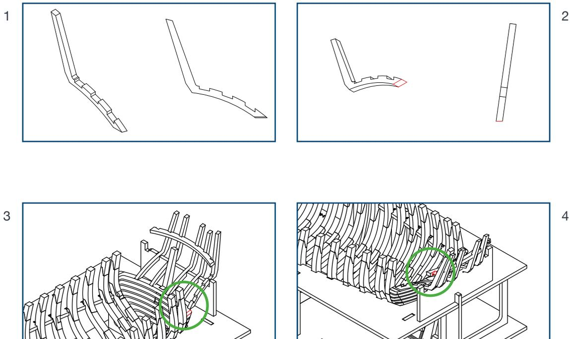
5 Staccate dalla tavoletta 6-07 il pezzo C (figura 1). Limate leggermente l'estremità evidenziata in rosso nella figura 2 per creare un piano inclinato; fate delle prove di montaggio e proseguite a limare fino a ottenere il risultato ottimale. Applicate una goccia di colla nelle sedi evidenziate in rosso nelle figure 3 e 4 e posizionate il pezzo C.
