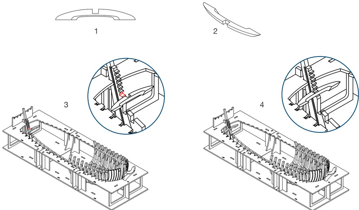
3 Il disegno 1 mostra la corretta posizione per incollare il gaisone. Il disegno 2 mostra lo scasso da inserire nel pettine. Applicare una goccia di colla sullo scalino evidenziato nella figura 3 e posizionate il gaisone (4).
