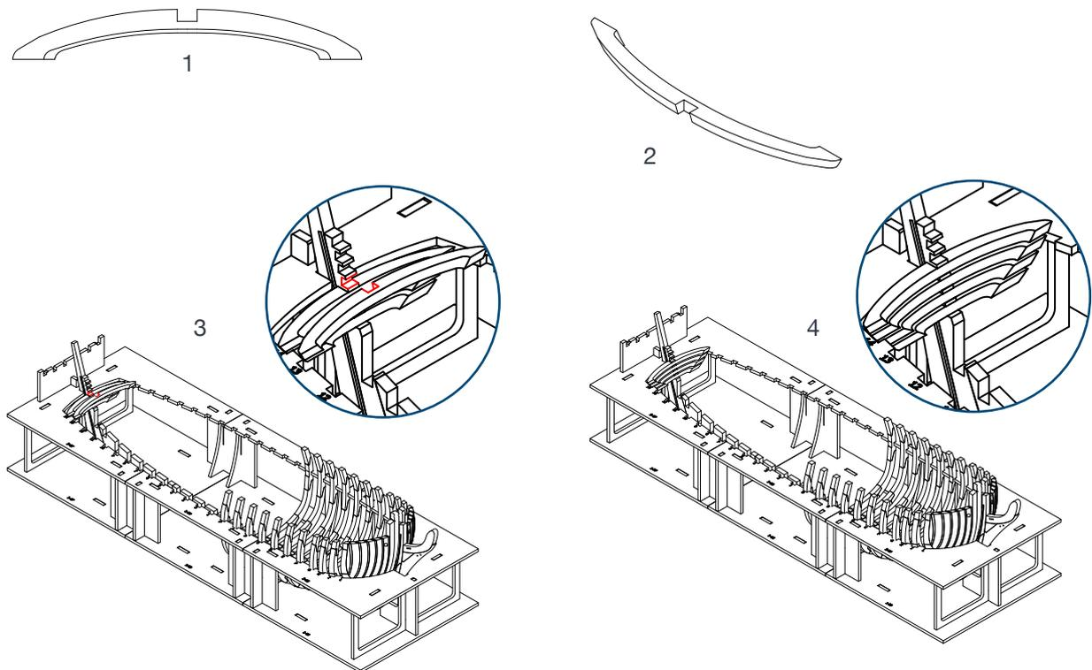
12 Il disegno 1 mostra la corretta posizione per incollare il gaisone. Il disegno 2 mostra lo scasso da inserire nel pettine. Applicare una goccia di colla sullo scalino evidenziato nella figura 3 e posizionate il gaisone (4).
