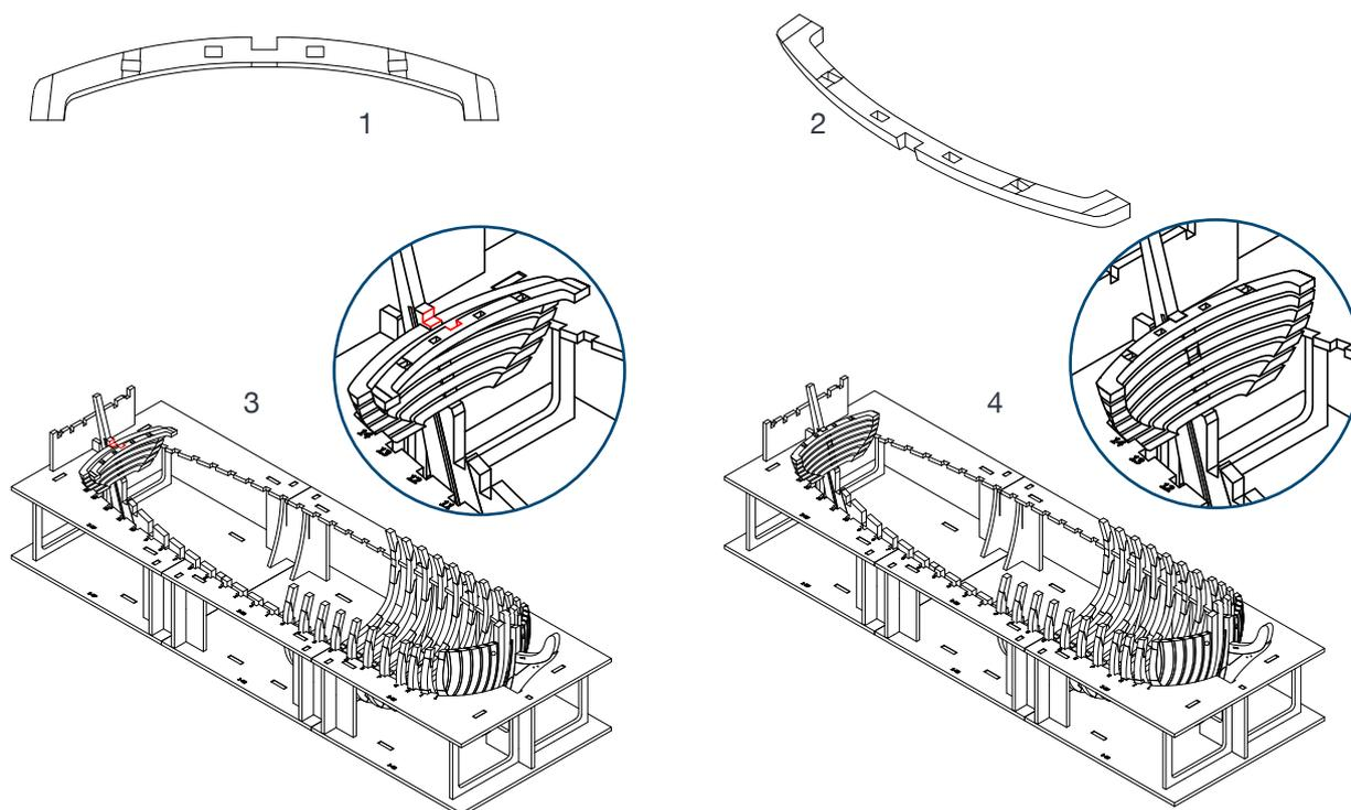
21 Il disegno 1 mostra la corretta posizione per incollare il gaisone. Il disegno 2 mostra lo scasso da inserire nel pettine. Applicare una goccia di colla sullo scalino evidenziato nella figura 3 e posizionate il gaisone (4).
