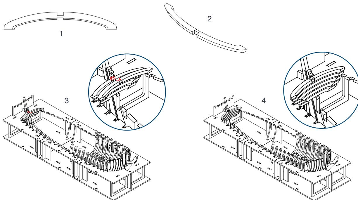
15 Il disegno 1 mostra la corretta posizione per incollare il gaisone. Il disegno 2 mostra lo scasso da inserire nel pettine. Applicare una goccia di colla sullo scalino evidenziato nella figura 3 e posizionate il gaisone (4).
