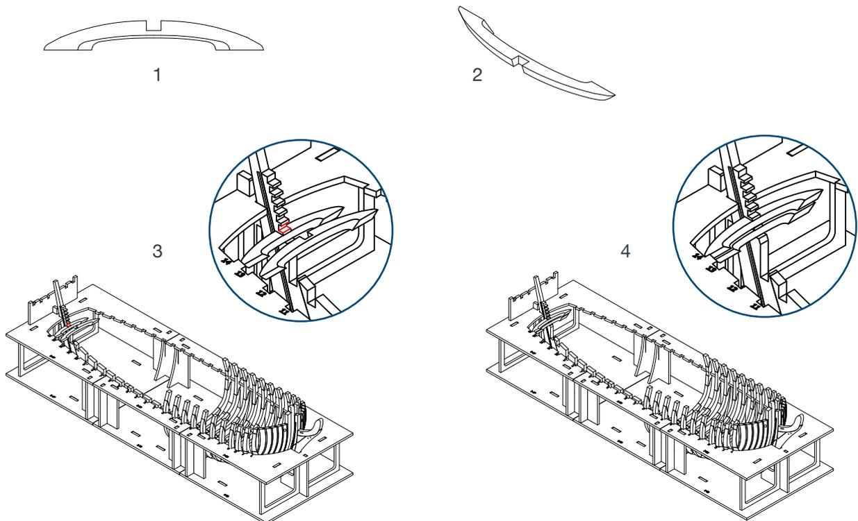
6 Il disegno 1 mostra la corretta posizione per incollare il gaisone. Il disegno 2 mostra lo scasso da inserire nel pettine. Applicare una goccia di colla sullo scalino evidenziato nella figura 3 e posizionate il gaisone (4).
