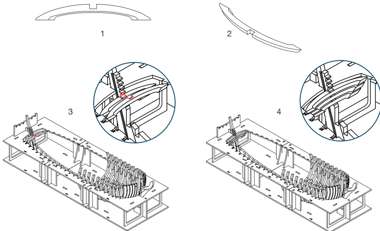
9 Il disegno 1 mostra la corretta posizione per incollare il gaisone. Il disegno 2 mostra lo scasso da inserire nel pettine. Applicate una goccia di colla sullo scalino evidenziato nella figura 3 e posizionate il gaisone (4).
