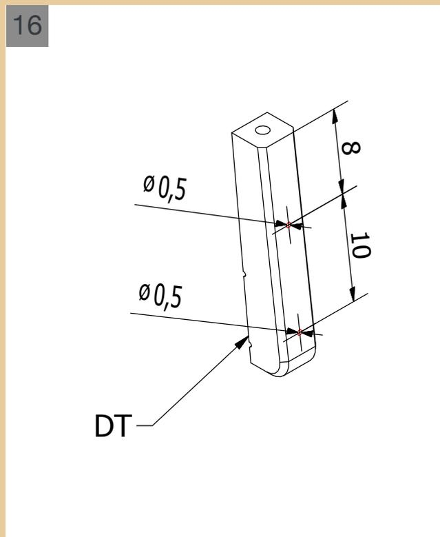
16 Eseguite su ognuno di essi due fori non passanti di 0,5 mm di diametro nelle posizioni indicate.
