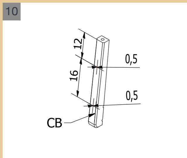
**10** Eseguite su ognuno di essi due fori non passanti di 0,5 mm di diametro nelle posizioni indicate.
