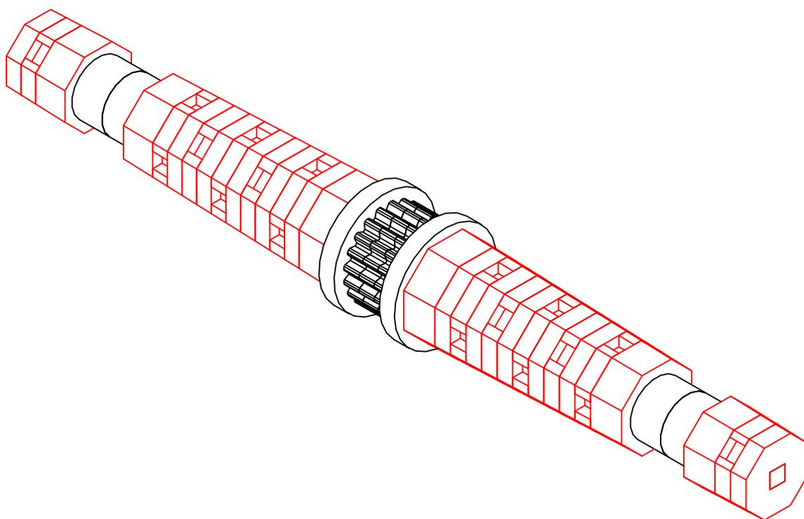
79 Arrivati a questo punto, limate gli spigoli dei pezzi evidenziati in rosso nell'immagine fino a ottenere una superficie continua. Una volta fatto, proseguite con il montaggio dell'organo osservando con attenzione le immagini delle pagine seguenti.
