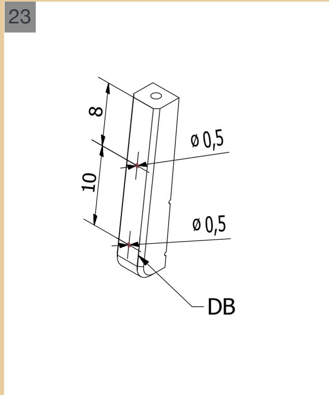
23 Eseguite su ognuno di essi due fori non passanti di 0,5 mm di diametro nelle posizioni indicate.
