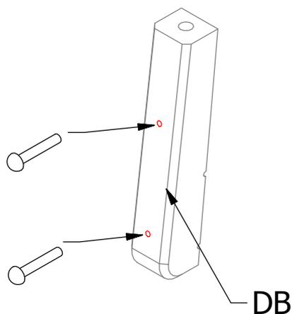
24 Prendete due chiodini, tagliateli della misura necessaria e inseriteli nei fori praticati sul lato di un supporto. La testa dei chiodini dovrà rimanere visibile. Ripetete la stessa operazione per l'altro supporto.
