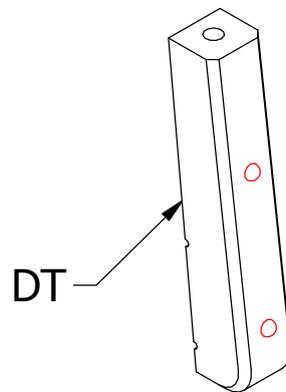
17 Prendete due chiodini, tagliateli della misura necessaria e inseriteli nei fori praticati sul lato di un supporto. La testa dei chiodini dovrà rimanere visibile. Ripetete la stessa operazione per l'altro supporto.
