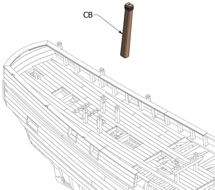
13 Unite i supporti CB al resto del modello, nelle posizioni indicate. Se necessario, limate le sporgenze dei pezzi.
