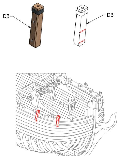
27 Unite i supporti DB al resto del modello, nelle posizioni indicate. Se necessario, limate le sporgenze dei pezzi.
