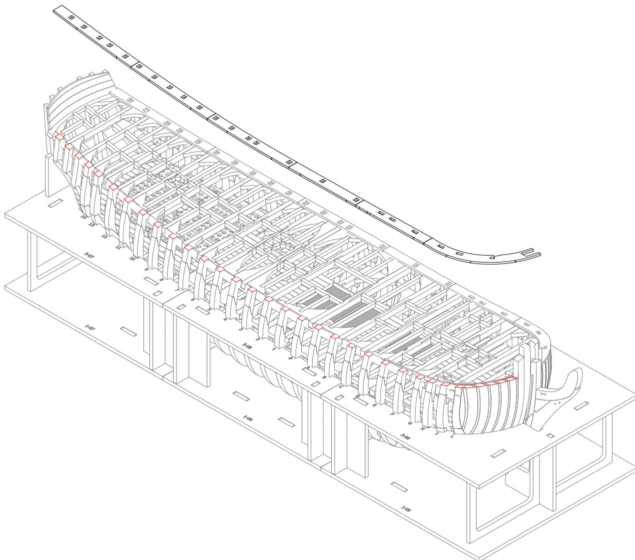
16 Unite il sostegno laterale al resto del vostro modello, applicando una goccia di colla alle parti evidenziate in rosso.
