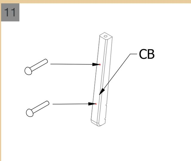
**11** Prendete due chiodini, tagliateli della misura necessaria e inseriteli nei fori praticati sul lato di un supporto. La testa dei chiodini dovrà rimanere visibile. Ripetete la stessa operazione per gli altri supporti.
