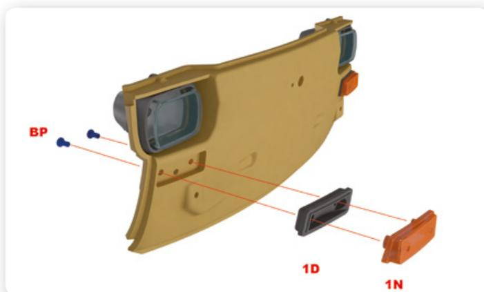
**6** Fissa l'alloggiamento dell'indicatore di direzione DX (1D) e la lente dell'indicatore di direzione DX (1N) sul musetto, mediante due viti BP.
