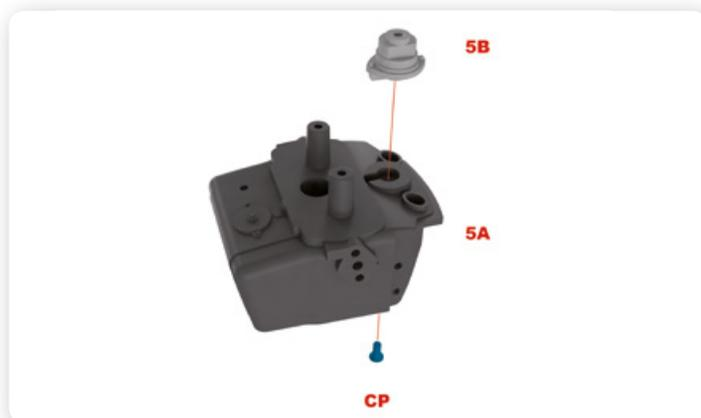
**3** Adesso posiziona e fissa il carburatore sul blocco motore superiore (5A). Potrai orientarlo in un solo modo.
