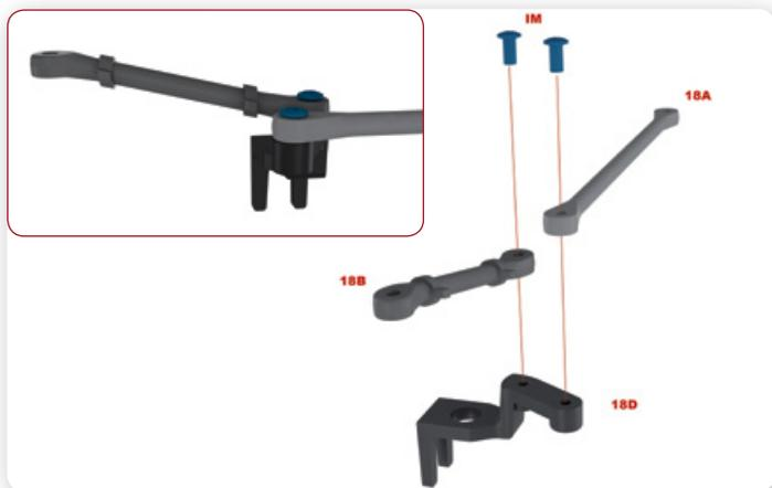
**1** Connetti il tirante (18A) e il tirante SX (18D) al braccio oscillante (18B) mediante due viti IM. Assicurati che il tirante SX sia rivolto verso l'alto.
