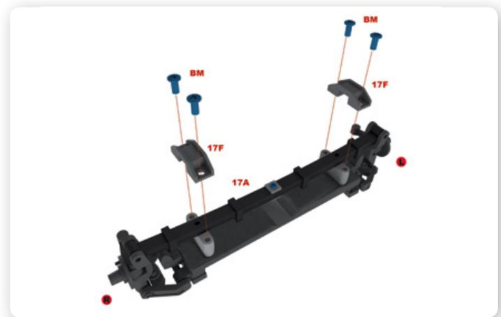
**4** Fissa i morsetti delle molle sui supporti, mediante delle viti BM.
