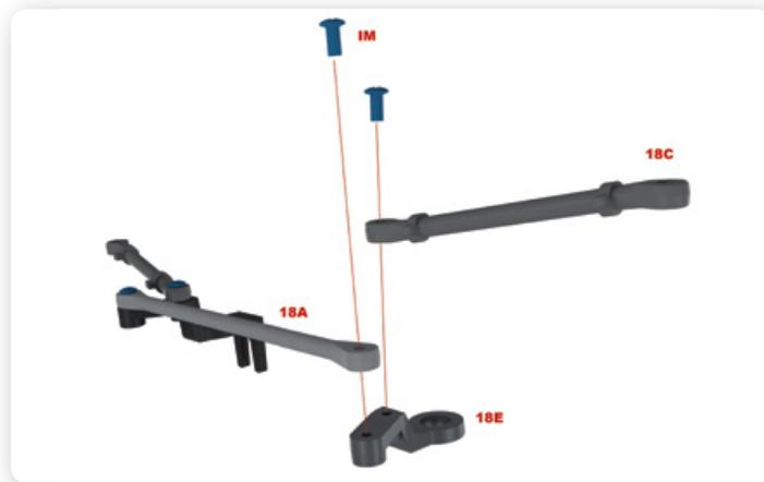
**2** Collega l'estremità libera del tirante e del tirante DX (18C) con il braccio dello sterzo (18E) mediante due viti IM, come mostrato.
