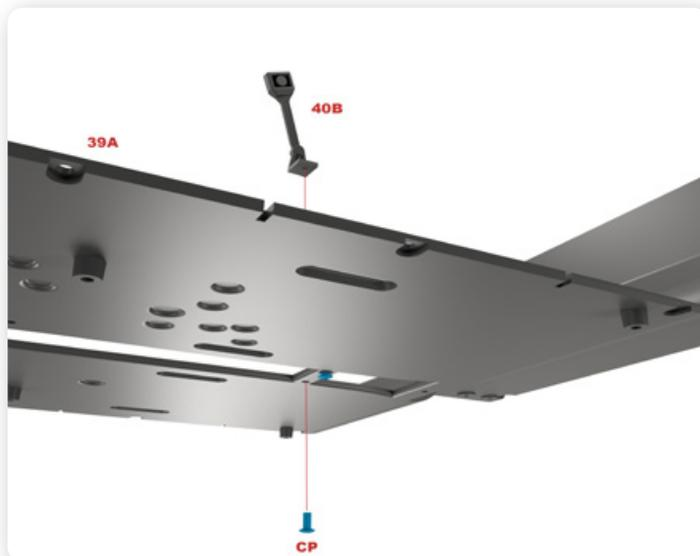
**2** Adesso colloca il supporto della cintura di sicurezza del passeggero (40B) sul pavimento, accanto a quello del guidatore. Fissalo con una vite CP.
