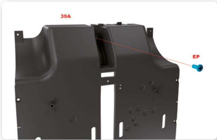
**3** Fissa l'accoppiatore dalla faccia inferiore del pavimento dell'abitacolo, usando una vite EP.
