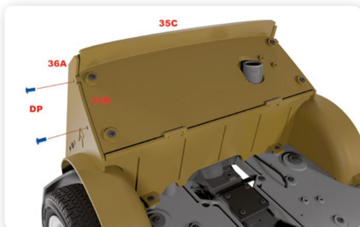
**7** Unisci la piastra superiore e il passaruota posteriore DX usando due viti DP.
