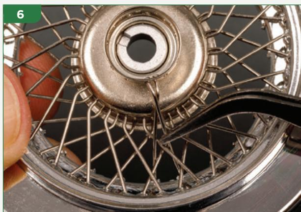
Ora prendi un raggio contrassegnato con la lettera "B". Utilizza le pinzette per posizionarlo attraverso i fori della fila superiore del mozzo. Il foro da utilizzare è quello che si trova sopra e a sinistra del raggio A usato al passo 4. Fai passare l'estremità del raggio attraverso la "V" formata dalla coppia adiacente di raggi interni.
