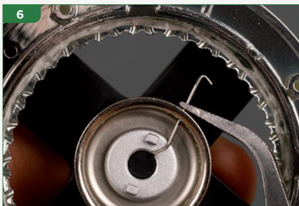
Utilizza le pinzette per inserire un raggio attraverso uno dei fori della fila inferiore del mozzo e tiralo fino a che l'estremità piegata avrà raggiunto il solco all'interno del cerchione.
