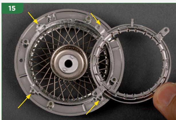
L'anello di fissaggio dei raggi è provvisto di una serie di tacche che corrispondono a quelle sul cerchione. Allinea le linguette per le viti con i fori indicati dalle frecce.
