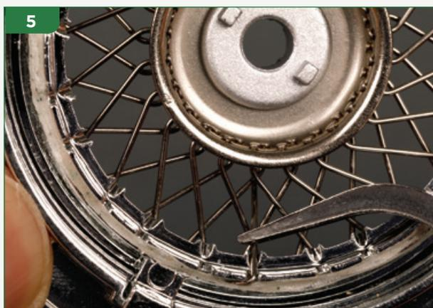
...capovolgì il cerchione e disponi l'estremità del raggio in uno dei solchi angolati del cerchione (ti sarà possibile raggiungere un solo solco). Premi l'estremità piegata del raggio contro il nastro biadesivo per tenerlo in posizione.
