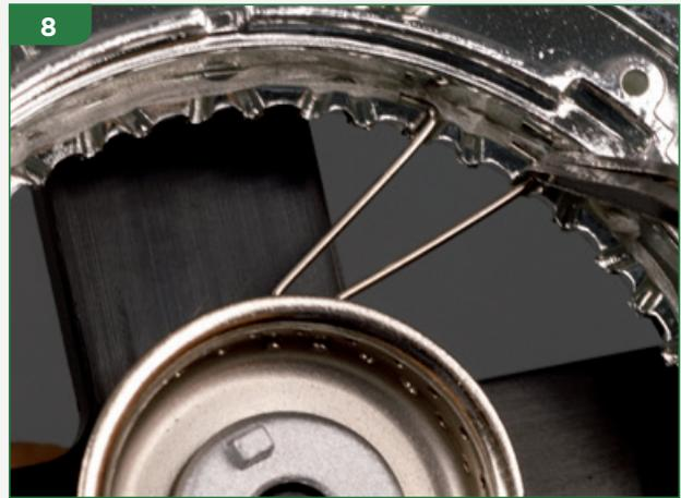
Con le pinzette posiziona un altro raggio nel foro successivo della fila inferiore all'interno del mozzo. Disponi il raggio come hai fatto allo Step 7, poggiando la punta nel solco del cerchione e premendola contro il biadesivo.
