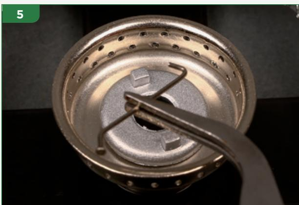
Ciascun raggio ha una estremità a forma di testa di chiodo che serve a fissare il raggio all'interno del mozzo centrale. I raggi presentano anche una doppia curvatura in modo da posizionarsi all'angolo corretto.
