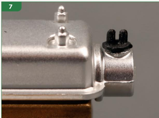
7 Ecco come dovrà apparire il connettore del generatore del contagiri dopo l'installazione.
