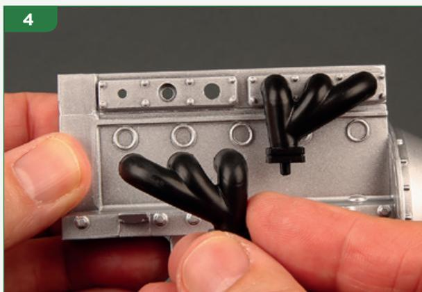
4 Inserisci i perni del collettore anteriore nei tre fori del blocco motore rimasti.
