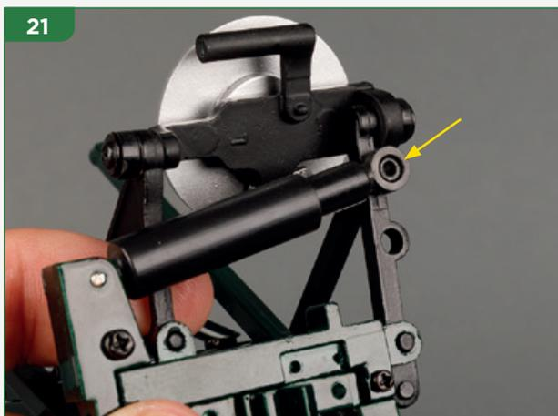
...unisci l'anello del tubo dell'ammortizzatore con il perno presente sul braccetto inferiore.
