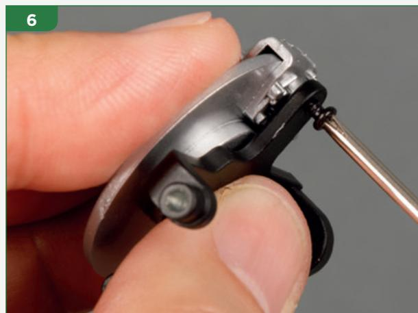
Serra una vite JP04 all'interno del foro di posizionamento.
