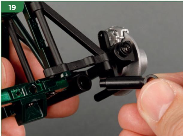
19 Fai attenzione a non fare cadere la molla, quindi installa il corpo dell'ammortizzatore all'interno del tubo dell'ammortizzatore, appoggiandolo sulla molla.
