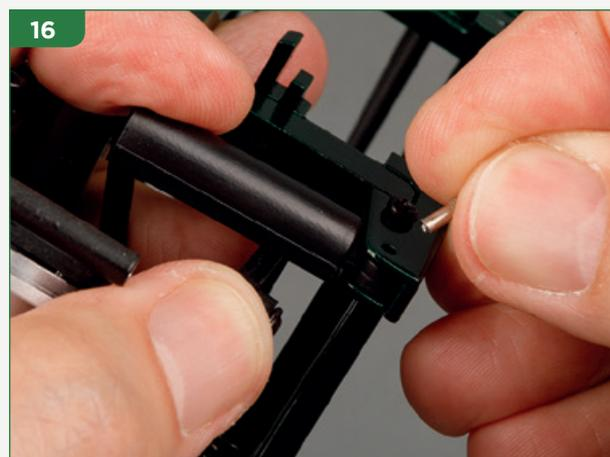
16 Il perno è dotato di un'estremità liscia e una zigrinata. Inserisci l'estremità liscia nel foro, assicurandoti di farla passare attraverso il foro dell'anello del tubo dell'ammortizzatore.
