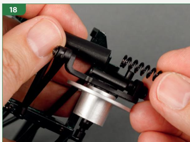
Inserisci la molla all'interno del tubo dell'ammortizzatore.
