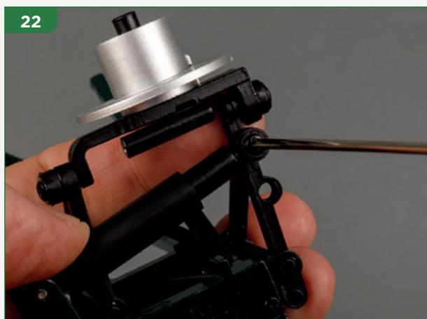
Fissa l'ammortizzatore sul braccetto inferiore mediante una vite JD05, senza forzarla.
