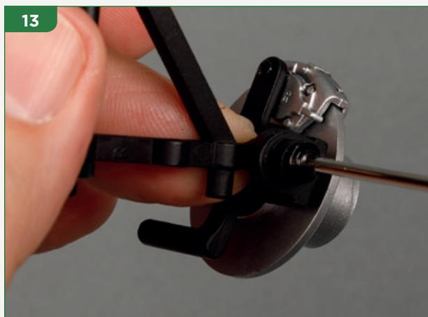
Fissa la boccola sul montante della sospensione mediante una vite JD06. Non stringerla eccessivamente, poiché il montante dovrà essere libero di ruotare.
