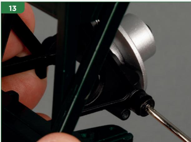
13 Fissa la boccia sul montante della sospensione mediante una vite JD06. Non stringerla eccessivamente, poiché il montante dovrà essere libero di ruotare.
