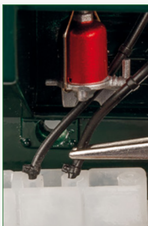
Innesta il secondo tubo nero nel secondo foro del serbatoio dei liquidi...
