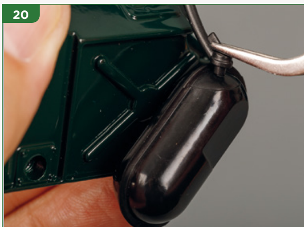
20 ...quindi innesta l'estremità del tubo nel foro del serbatoio sottovuoto.
