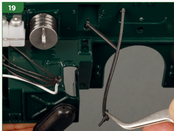
19 Usa le pinzette per prendere l'estremità più lunga dei tubi sottovuoto a 'Y' del sistema frenante...
