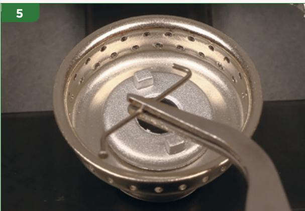
Ciascun raggio è dotato di un'estremità a testa di chiodo. Essa ti permetterà di fissarlo sul mozzo. Inoltre ogni raggio è dotato di una doppia curvatura che servirà per posizionarlo correttamente.
