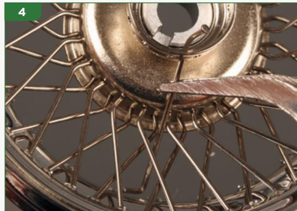
Inizia a lavorare con i raggi contrassegnati con la lettera "A". Aiutandoti con le pinzette, posiziona un raggio in uno dei fori della fila inferiore del mozzo. Fai passare l'estremità piegata del raggio attraverso la "V" formata dalla coppia più vicina di raggi interni...
