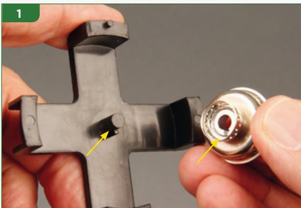
Innesta il mozzo nel perno centrale della dima, appoggiandolo sulla flangia più stretta. **Fai corrispondere la fessura del foro centrale (indicata dalla freccia) con la linguetta corrispondente del perno.**
