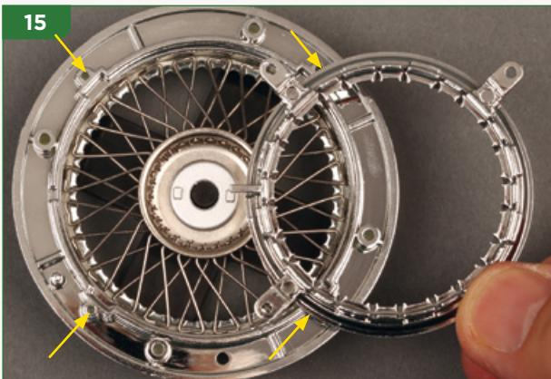
L'anello di fissaggio dei raggi è provvisto di una serie di tacche che corrispondono a quelle sul cerchione. Allinea le lingue per le viti con i fori indicati dalle frecce.
