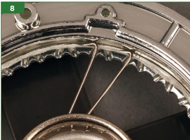
Con le pinzette posiziona un altro raggio nel foro successivo della fila inferiore all'interno del mozzo. Disponi il raggio come hai fatto nello Step 7, poggiando la punta nel solco del cerchione e premendola contro il biadesivo.
