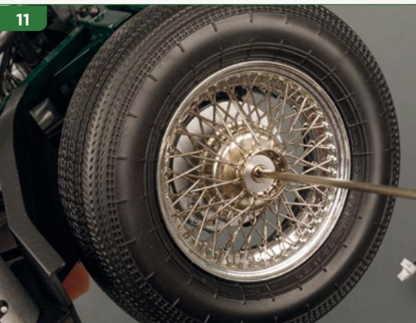
Serra una vite JP07 nel foro centrale, così da fissare la ruota. Verifica che essa sia libera di ruotare senza impedimenti.
