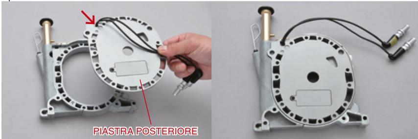
Installa la piastra posteriore rispettando l'orientamento mostrato in foto. I cavi elettrici devono uscire dalla tacca indicata.
