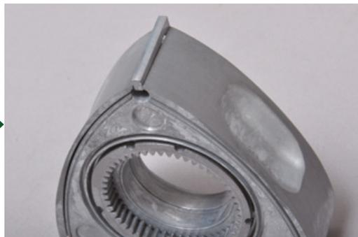
Premi in maniera uniforme in modo che gli spigoli non sporgano rispetto al profilo del rotore.
