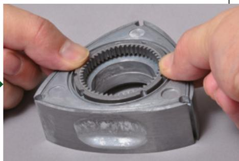
Posiziona la tavoletta e batti con il martello per inserire a fondo l'ingranaggio.
