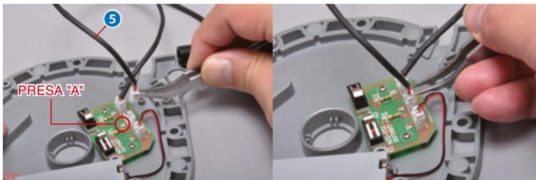
Inserisci la spinetta del cavo elettrico nella presa "A" della centralina.
