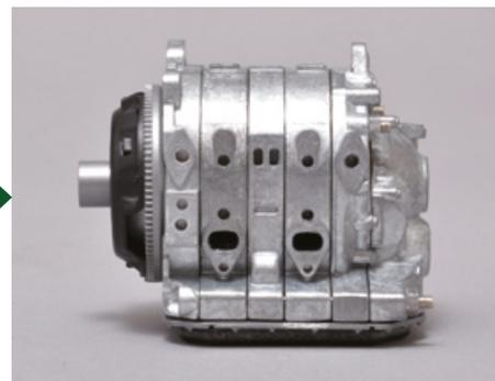
Spingi sul volano fino a mandarlo in battuta con la faccia del motore.
