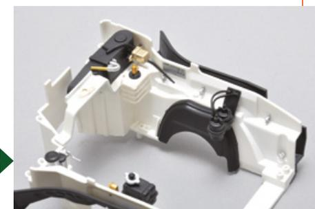
Puoi riposizionare l'impianto di riscaldamento, il serbatoio del liquido tergilassanti e la bobina di accensione. Si tratta ancora di un montaggio temporaneo, non incollare i pezzi.
