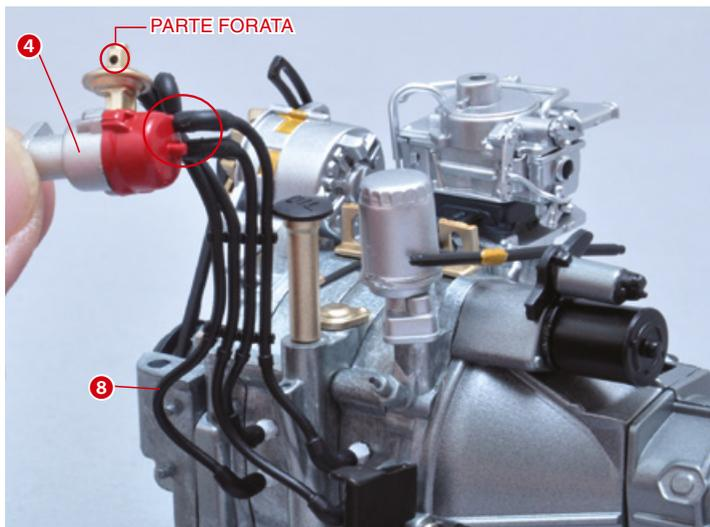
Unisci i due cavi della metà di destra della sezione superiore alla calotta dello spinterogeno A, come mostrato.
