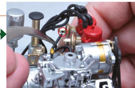
Ora inserisci l'estremità più corta dell'altro tubo flessibile nel foro dello spinterogeno A, come mostrato.
