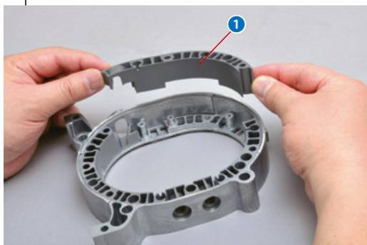
Unisci la parte T dell'alloggiamento del rotore al gruppo assemblato nelle fasi precedenti.
