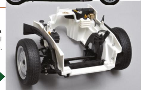
Colloca la parte frontale della carrozzeria sopra le sospensioni anteriori. Fai attenzione ad abbinare correttamente tacche e ingranaggi, come mostrato.
