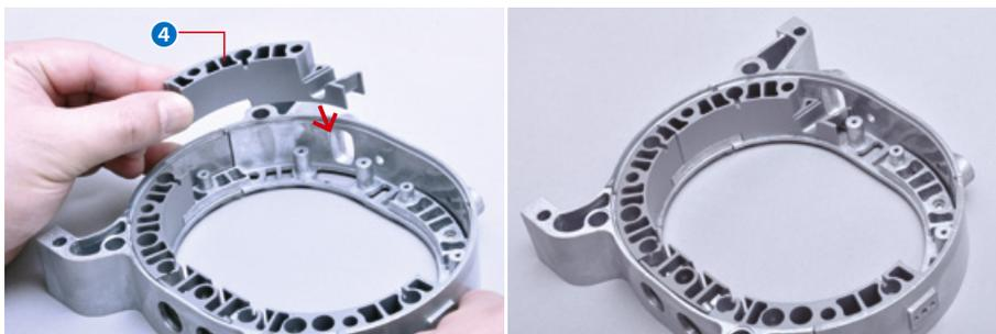
Unisci la parte S dell'alloggiamento del rotore al gruppo assemblato nelle fasi precedenti.
