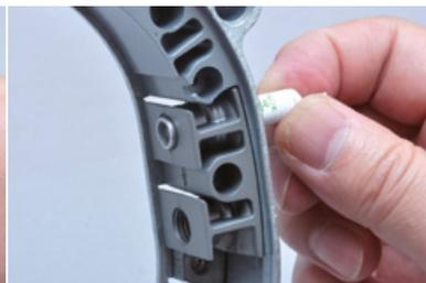
Prova ad avvitare una candela (parte 4 fase 14 o parte 4 fase 16) nelle sedi sul lato dell'alloggiamento per verificare che non ci siano problemi. Rimuovila dopo aver effettuato il test.
