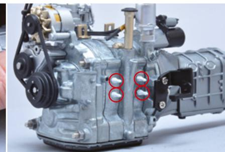
Inserisci le quattro candele nei rispettivi fori sul lato sinistro del blocco motore. Osserva le foto per identificare il corretto verso di montaggio.
