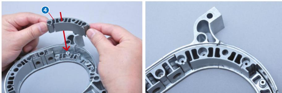
Unisci la parte R dell'alloggiamento del rotore al gruppo assemblato nelle fasi precedenti.
