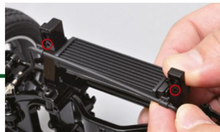
Inserisci i due perni dello stabilizzatore nei fori indicati.
