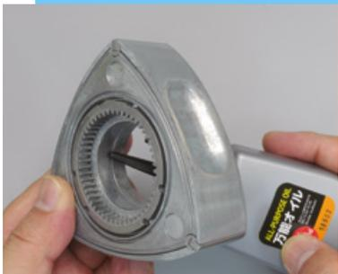
Applica un sottile strato di lubrificante per modellismo sulla superficie esterna del rotore e sulla sua scanalatura interna, come mostrato.
