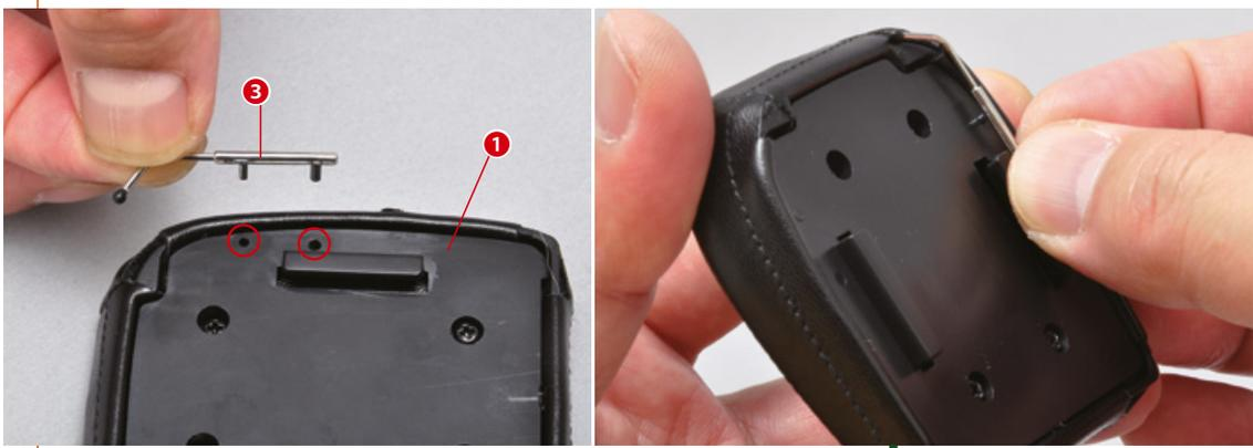
Unisci la leva al lato inferiore del cuscino del sedile, orientando i pezzi come mostrato. Regolerai la distanza del sedile dal pianale in una delle prossime fasi.
