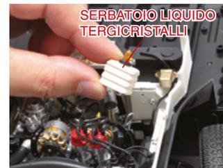
Rimuovi temporaneamente il serbatoio del liquido tergcristalli.
