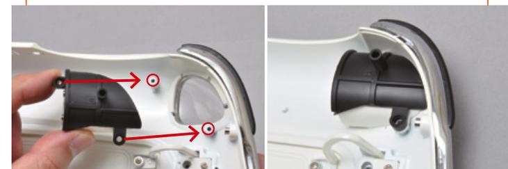
Unisci il faro anteriore destro alla sezione frontale della carrozzeria.
