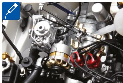
Fissa la pompa del vuoto al gruppo motore con una goccia di adesivo.
