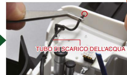
Fai passare il tubo di scarico dell'acqua (già parzialmente installato nella fase 35) attraverso i passacavi e inserisci la sua estremità nel foro indicato.
