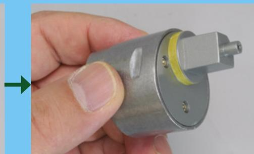
Nell'esempio che ti mostriamo, abbiamo aumentato il suo spessore applicando alcune striscioline di nastro adesivo.
