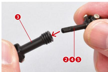
Inserisci il giunto interno del gruppo appena assemblato nel giunto esterno che avevi installato sul differenziale.
