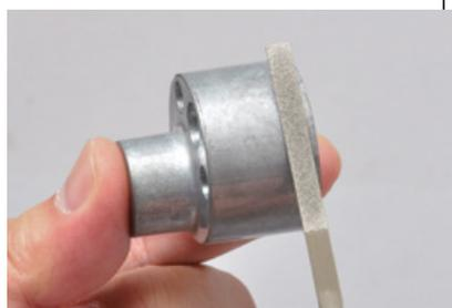
Se i pezzi non ruotano in maniera regolare, puoi limare il profilo della camma per eliminare gli eventuali difetti di produzione.
