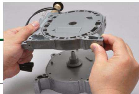
Orienta i pezzi esattamente come mostrato e posiziona l'alloggiamento intermedio sull'alloggiamento del rotore.
