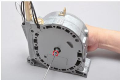
Rimuovi la vite indicata e rimuovi la camma dall'interno dell'alloggiamento.
