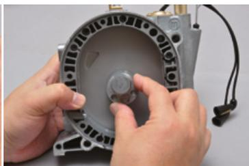
Posiziona il gruppo della camma nel foro dell'alloggiamento del rotore, facendo coincidere le sagome dei pezzi.
