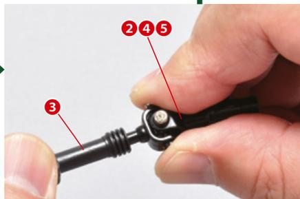
Il primo giunto cardanico correttamente assemblato.
