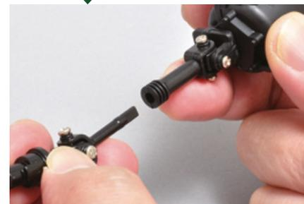
Ripeti gli step precedenti per assemblare e posizionare anche il secondo giunto cardanico, all'altra estremità del differenziale.
