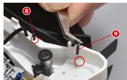
Installa i due passacavi sul profilo destro della carrozzeria, esattamente come mostrato.
