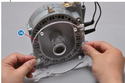
Installa temporaneamente il pannello trasparente sull'alloggiamento.
