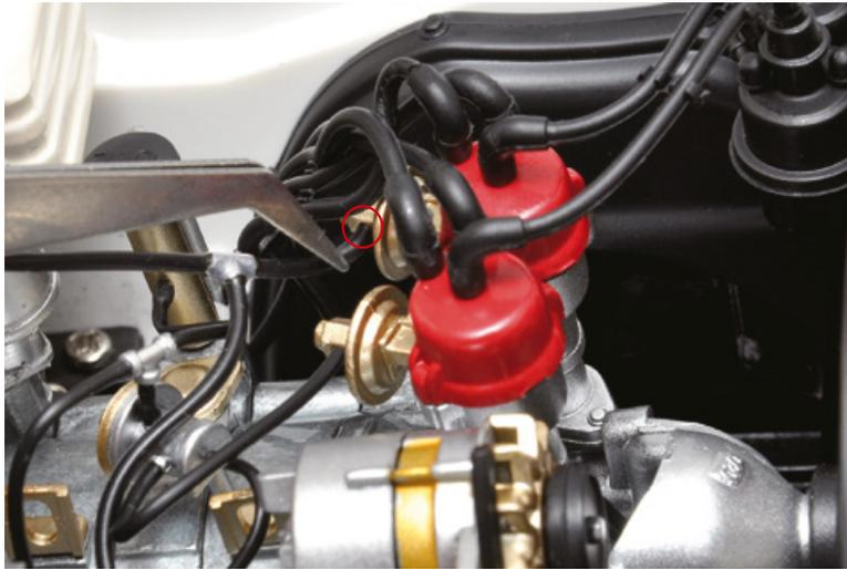
Inserisci l'estremità più corta del tubo sagomato a T del carburatore A, da cui l'avevi rimosso nello step 3.
