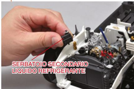
Rimuovi temporaneamente il serbatoio secondario del liquido refrigerante.
