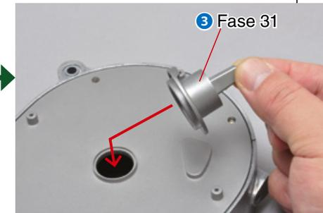
Posiziona l'adattatore della manopola (n. 3 fase 31) sul foro centrale dell'alloggiamento del rotore, orientando i pezzi come mostrato.
