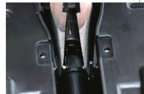
Ruota il giunto della trasmissione e aiutati con la pinza per stringere in posizione il perno.
