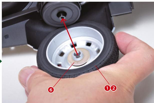
Inserisci la rondella sul perno del lato interno del cerchione. Unisci la ruota all'estremità del semiassse posteriore.
