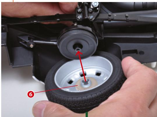
Recupera la ruota che hai assemblato nella fase 52 e inserisci la rondella sul suo lato interno. Unisci la ruota all'altra estremità del semiassse posteriore.
