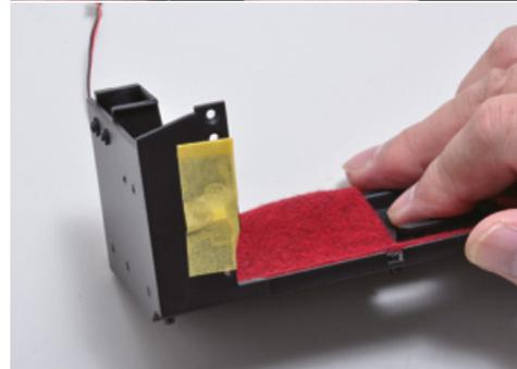
Manda in battuta i componenti e fissali temporaneamente con una striscia di nastro adesivo.
