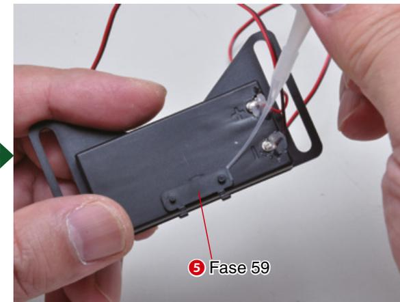
Ti consigliamo di applicare una piccola quantità di colla prima di spingere a fondo la cerniera, in modo da unire saldamente i componenti.
