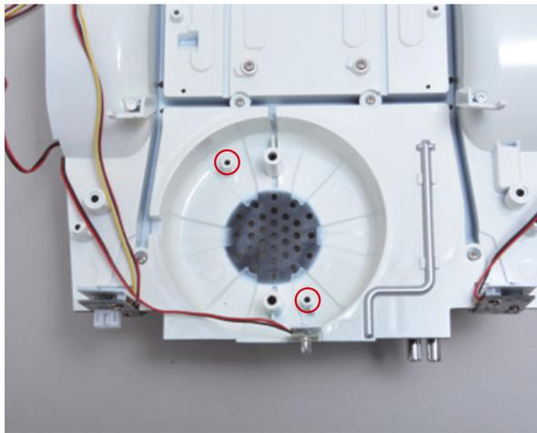
Identifica i perni forati che ti serviranno per fissare l'altoparlante al pianale.
