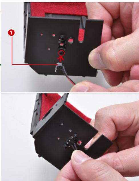
Unisci l'interruttore del cablaggio alla sezione del pianale.
