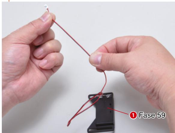
Recupera il portabatterie che hai ricevuto con la fase 59 e srotola il cavo del cablaggio.
