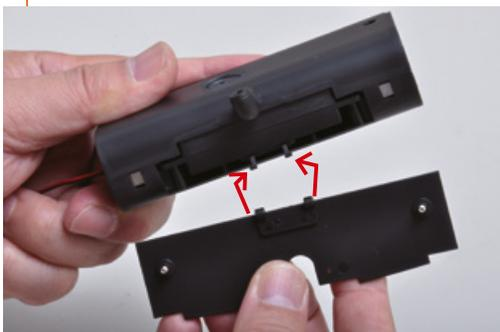
Maneggia con cura le cerniere per evitare di danneggiare i pezzi.
