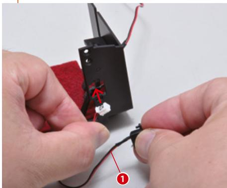
Inserisci la spinetta del cablaggio 1 nel foro della sezione del pannello del guidatore, come mostrato.
