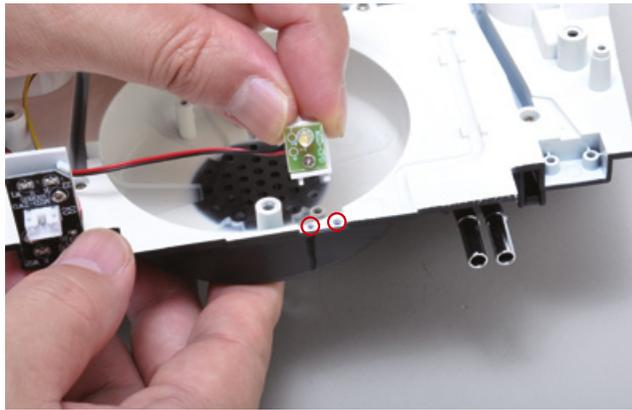
Unisci il supporto con il cablaggio alla parte posteriore del pianale, orientando i pezzi come mostrato.
