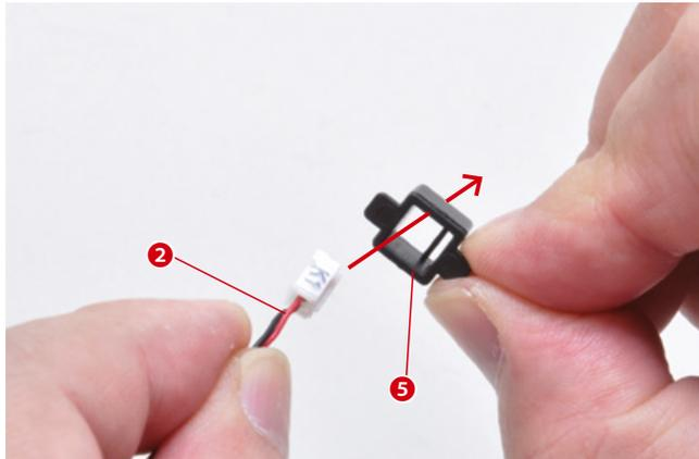
Inserisci la spinetta del cablaggio 2 nel secondo supporto, orientando i pezzi come mostrato.
