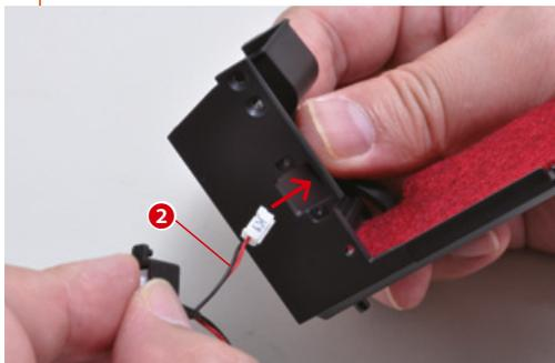
Inserisci la spinetta del cablaggio 2 nel foro della sezione del pianale del passeggero, come mostrato.
