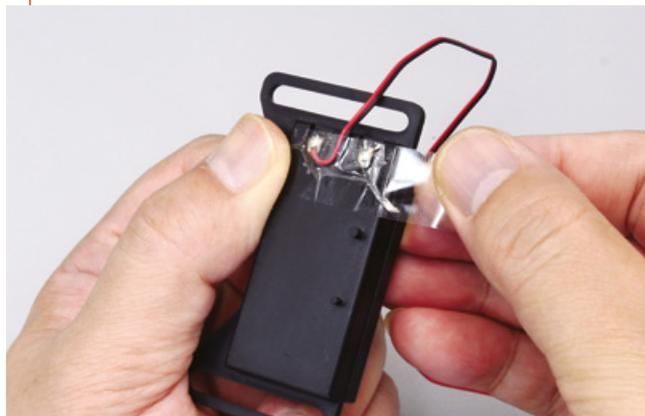
Disponi il cavo del portabatterie come mostrato e fissalo in posizione con del nastro adesivo per evitare di danneggiarlo.
