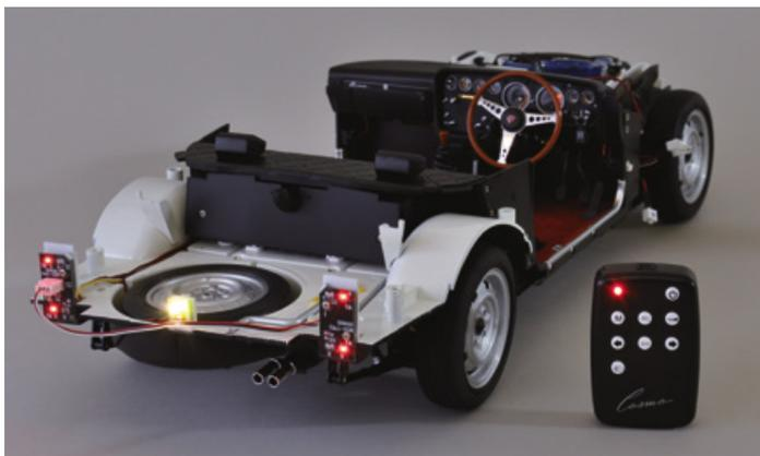
Prova a premere ogni pulsante per verificare il funzionamento degli effetti del tuo modello (le luci della parte anteriore verranno verificate una volta installate). Dopo aver effettuato la verifica, rimuovi le batterie del tuo modello e del telecomando per non consumarle.
