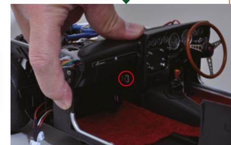
Premendo sugli interruttori delle portiere le luci di cortesia si spengono. A modello finito, le luci di cortesia si accenderanno quando aprirai le portiere e resteranno spente finché le portiere saranno chiuse.
