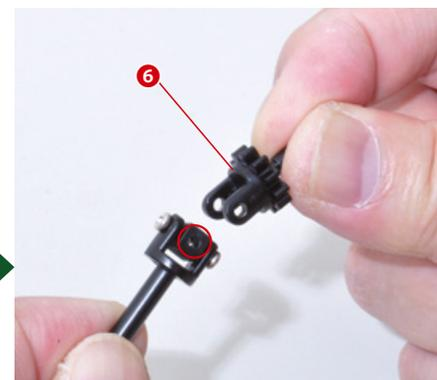
Unisci l'ingranaggio al giunto installato sul piantone dello sterzo.
