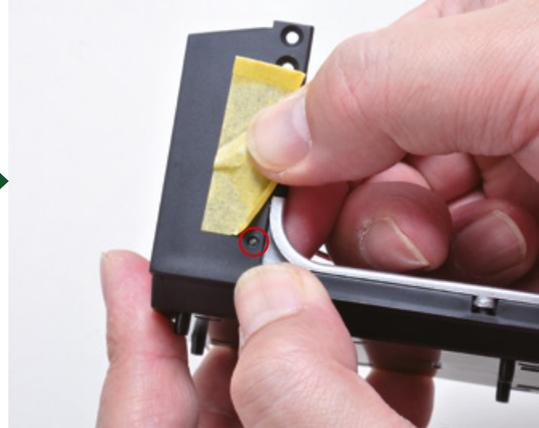
Verifica che il perno del dettaglio sia inserito nel foro evidenziato nell'immagine.
