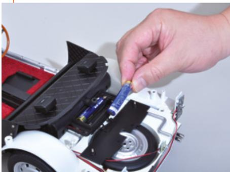
Inserisci due batterie AAA nel portabatterie, come mostrato. Fai attenzione a orientare correttamente i poli delle batterie.
