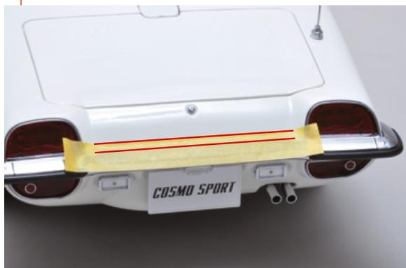
Applica una striscia di nastro adesivo sulla sezione posteriore del tuo modello, come mostrato. La sezione indicata in rosso nella foto misura circa 5 mm.
