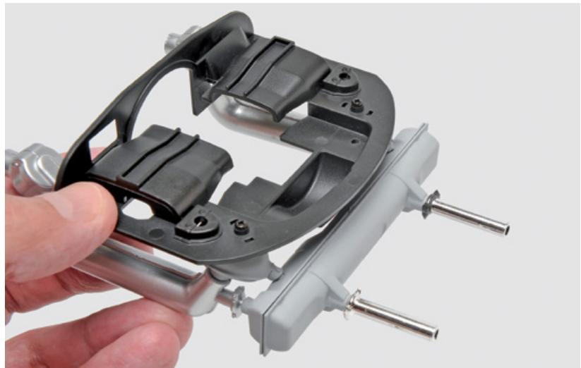
**STEP 12-D.** Anche i due tubi che collegano la marmitta sono dotati di flange, che potrai verniciare nel solito modo.
