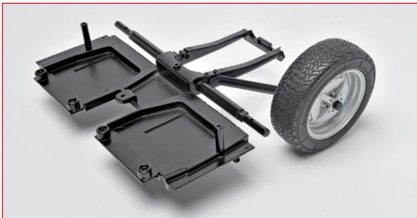
Il sottotelaio, il braccio della sospensione e la ruota alla fine di questa fase di assemblaggio.
