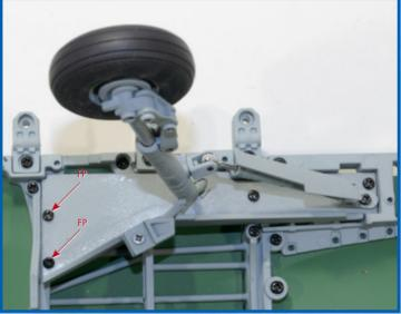
Alza il carrello così da liberare i fori della parete del carrello. Fissa quest'ultima sul telaio con due viti MM e due viti FP.
