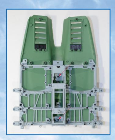
Installa la travatura al centro della fusoliera usando due viti VM, come mostrato. Hai completato questa fase di assemblaggio.
