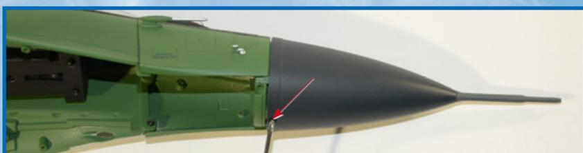
**6** Coloca el radomo (D007) en el escáner y el fuselaje, tal y como se muestra. Fíjalo desde abajo con un tornillo DM.
