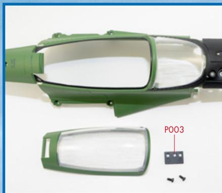
**4** Prepara el carenado, la placa de bisagra (P003) y dos tornillos VM.
