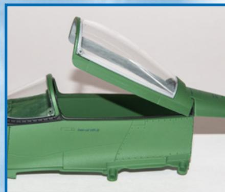
**7** He aquí la estructura de la cabina y del carenado al final de esta fase. Verifica el funcionamiento de la bisagra y que el carenado frontal pueda bloquearse en una posición elevada.
