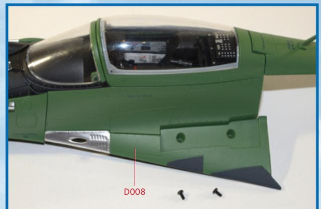
**2** Fija el carenado delantero izquierdo (D008) en el lado izquierdo del fuselaje, utilizando, tal y como se muestra, dos tornillos CM.
