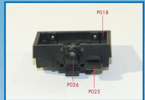
**1** Coloca el indicador ILS (P026) y el indicador de navegación (P025) en los orificios superiores del panel de instrumentos (P018).
