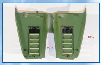
Inserta la rejilla de la salida de aire derecha en la abertura del lado derecho del fuselaje y fíjalo desde el interior con tres tornillos AP.
